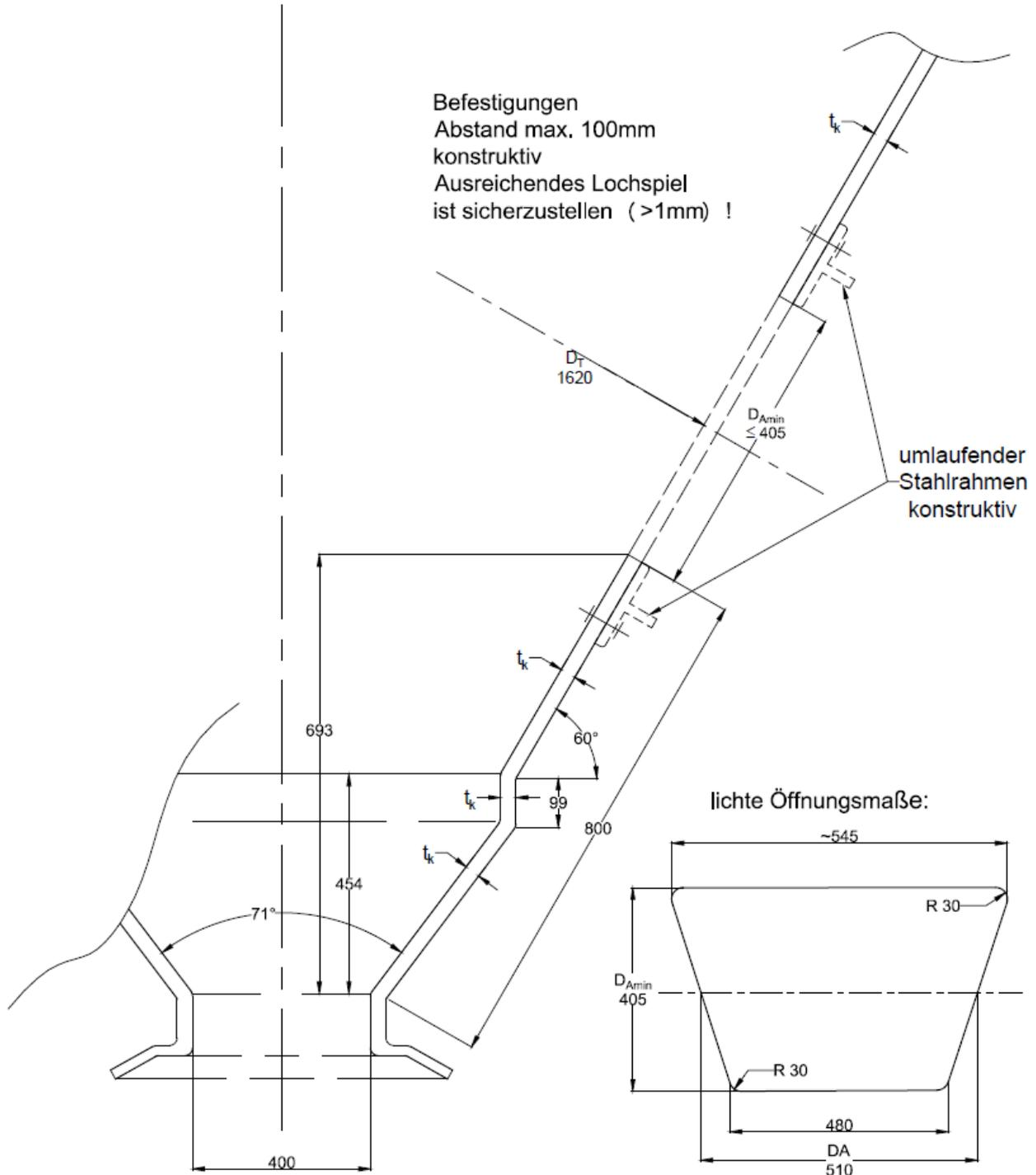
$t_k$  gemäß Hinterlegungen (Statische Nachweise/Gutachten: Silos ohne/mit Öffnungen und ohne/mit Trichterabstufung im Silotrichter)
