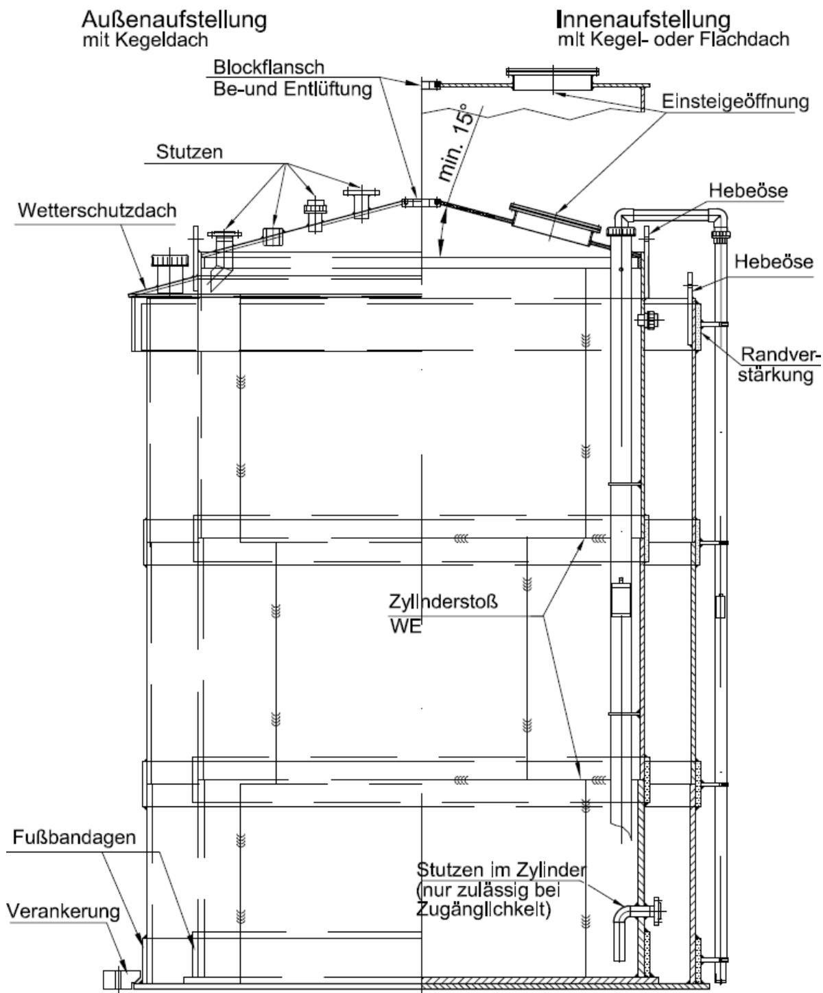
Zylindrische Flachbodenbehälter und Auffangvorrichtungen
