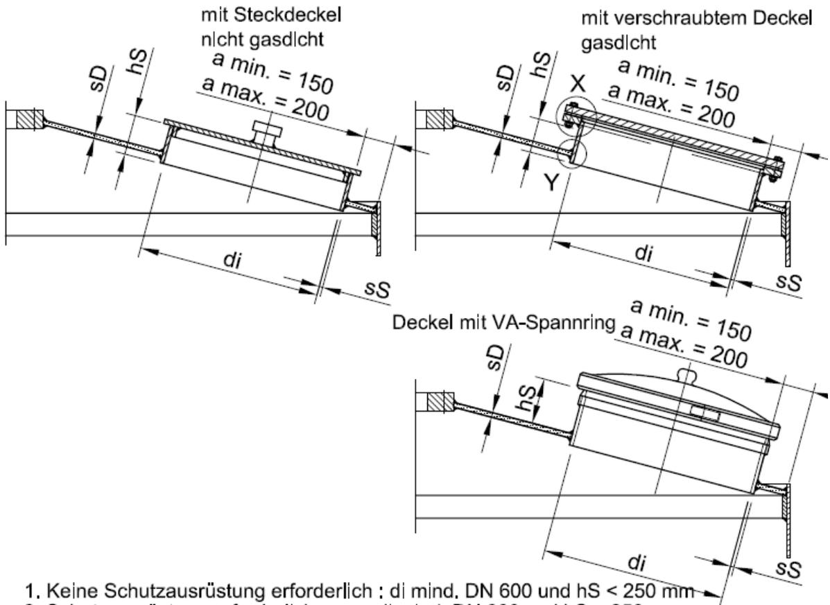
1. Keine Schutzausrüstung erforderlich : di mind. DN 600 und hS < 250 mm
