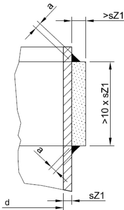
Die Randverstärkung darf auch an der Innenfläche der Auffangvorrichtung angebracht werden.
