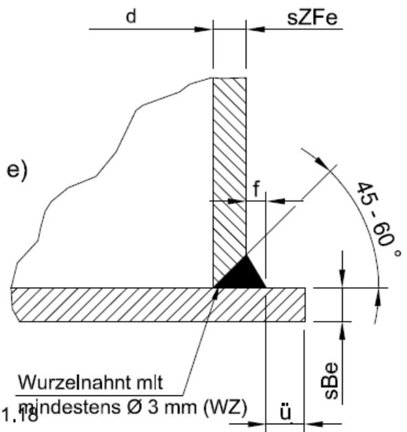
Wurzelnahnt mit mindestens  $\varnothing 3$  mm (WZ)
