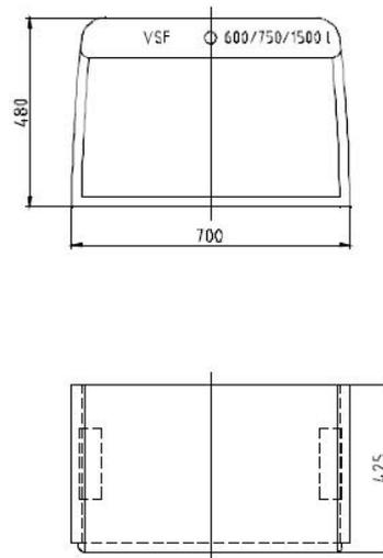
Blasgeformte Behälter mit integrierter Auffangwanne
