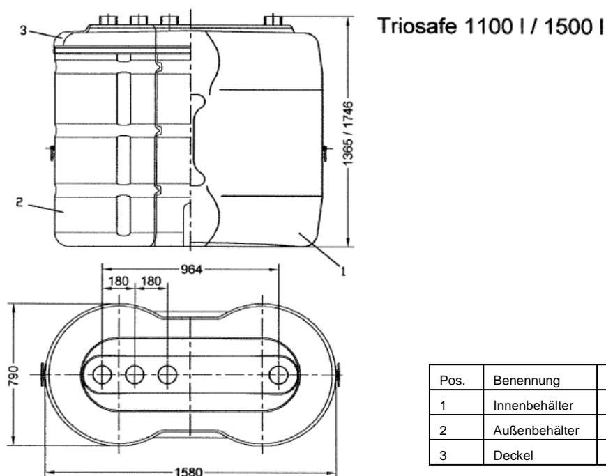
Blasgeformte Behälter mit integrierter Auffangvorrichtung aus Polyethylen (PE-HD)
