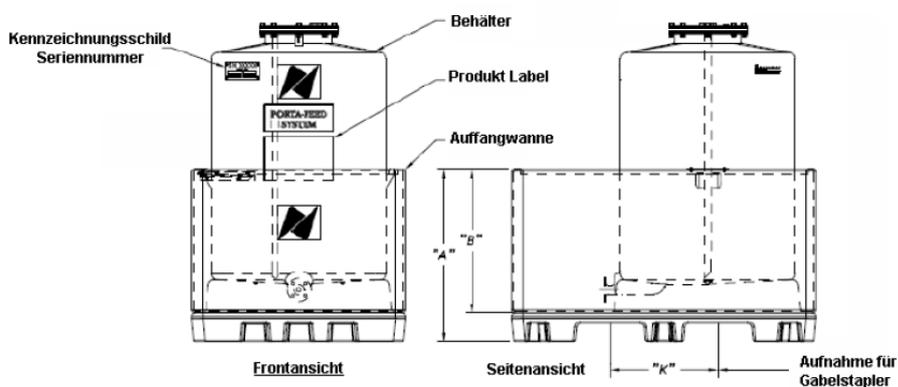
Rotationsgeformte Behälterkombinationen Nalco Porta-Feed System aus Polyethylen (PE)
