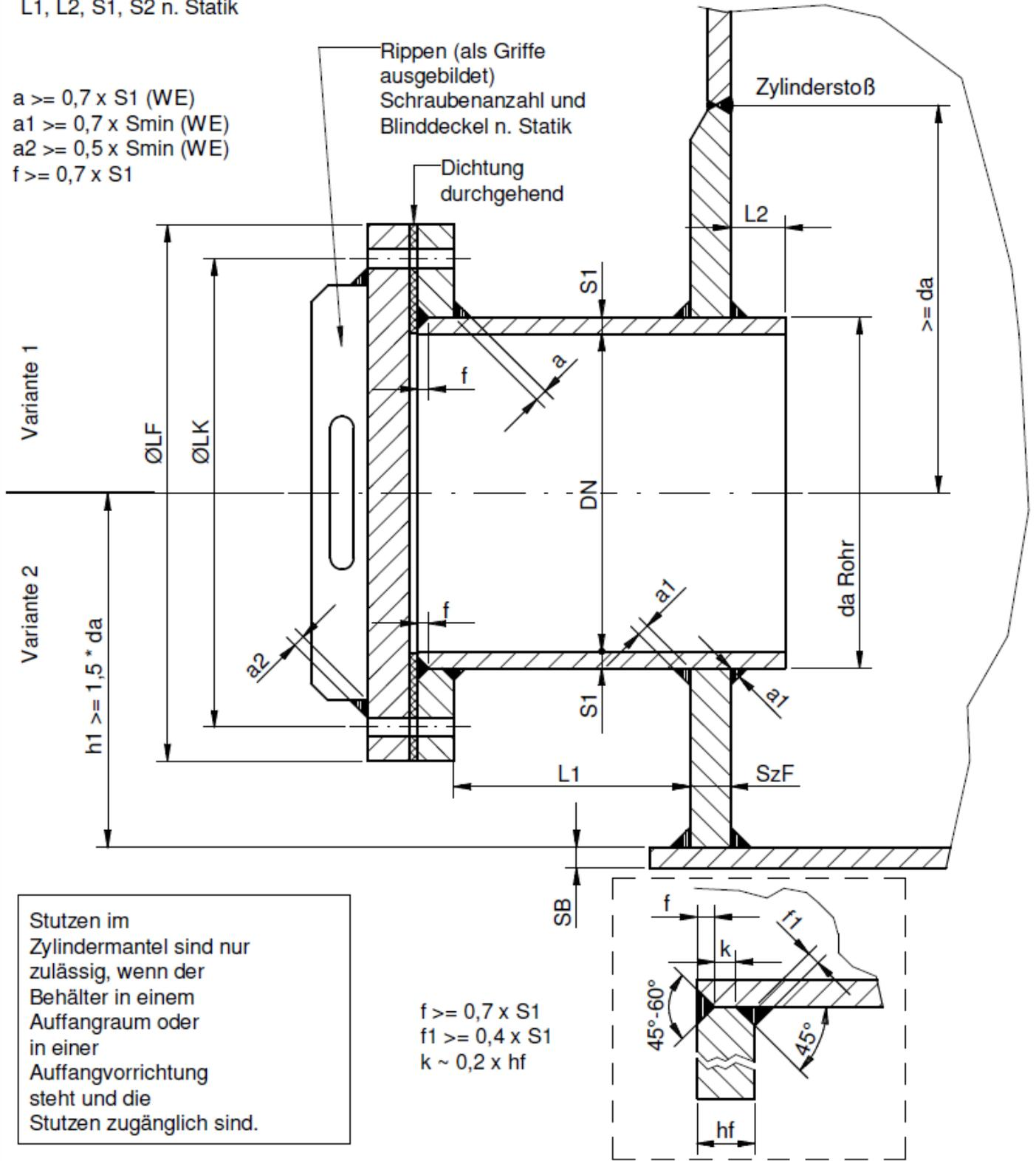
Stützen im Zylindermantel sind nur zulässig, wenn der Behälter in einem Auffangraum oder in einer Auffangvorrichtung steht und die Stützen zugänglich sind.
