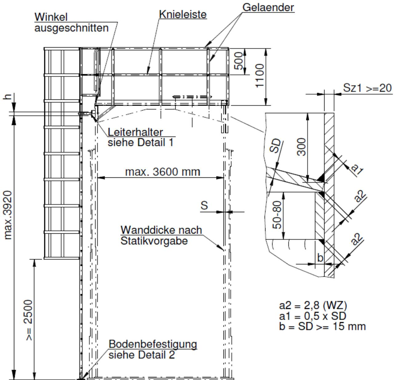
Letzte Sprosse in Rosthöhe der Gitterbühne. Von dort aus mit Abstand 280 mm nach unten anordnen. Mass "h" am Leiterhalter (Detail 1) muss ausreichend gross zur Kompensation von Temperaturschwankungen und Ausgleich unterschiedlicher Behälterhöhen sein. Das erforderliche Mass "h" ist nachzuweisen.
