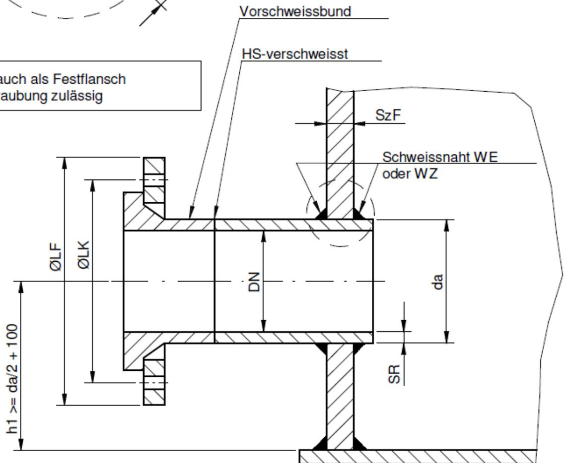
Stützen max. DN150 (da 160 mm) /
