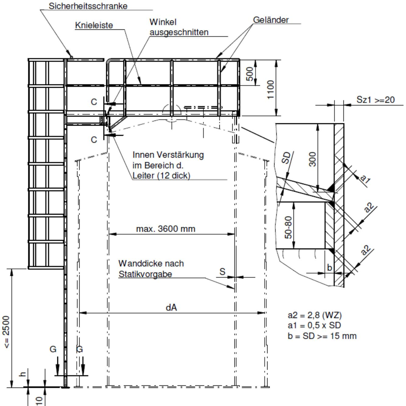
Letzte Leitersprosse in Rosthöhe der Gitterbühne. Von dort aus die Sprossen mit Abstand 280 mm nach unten anordnen. Mass "h" am Leiterfuss muss ausreichend gross zur Kompensation von Temperaturschwankungen und Ausgleich unterschiedlicher Behälterhöhen sein. Das erforderliche Mass "h" ist nachzuweisen.
