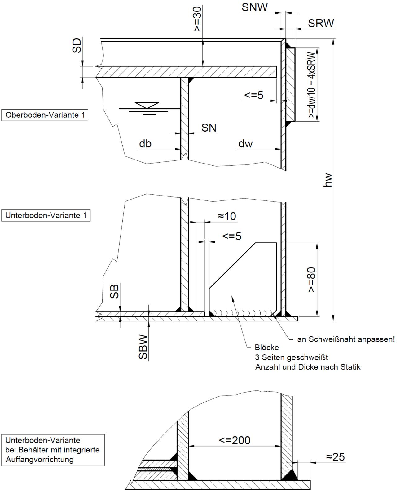
Zylindrische Flachbodenbehälter und Auffangvorrichtungen aus verschweißten Tafeln (Tafelbehälter) aus Polyethylen (PE)
