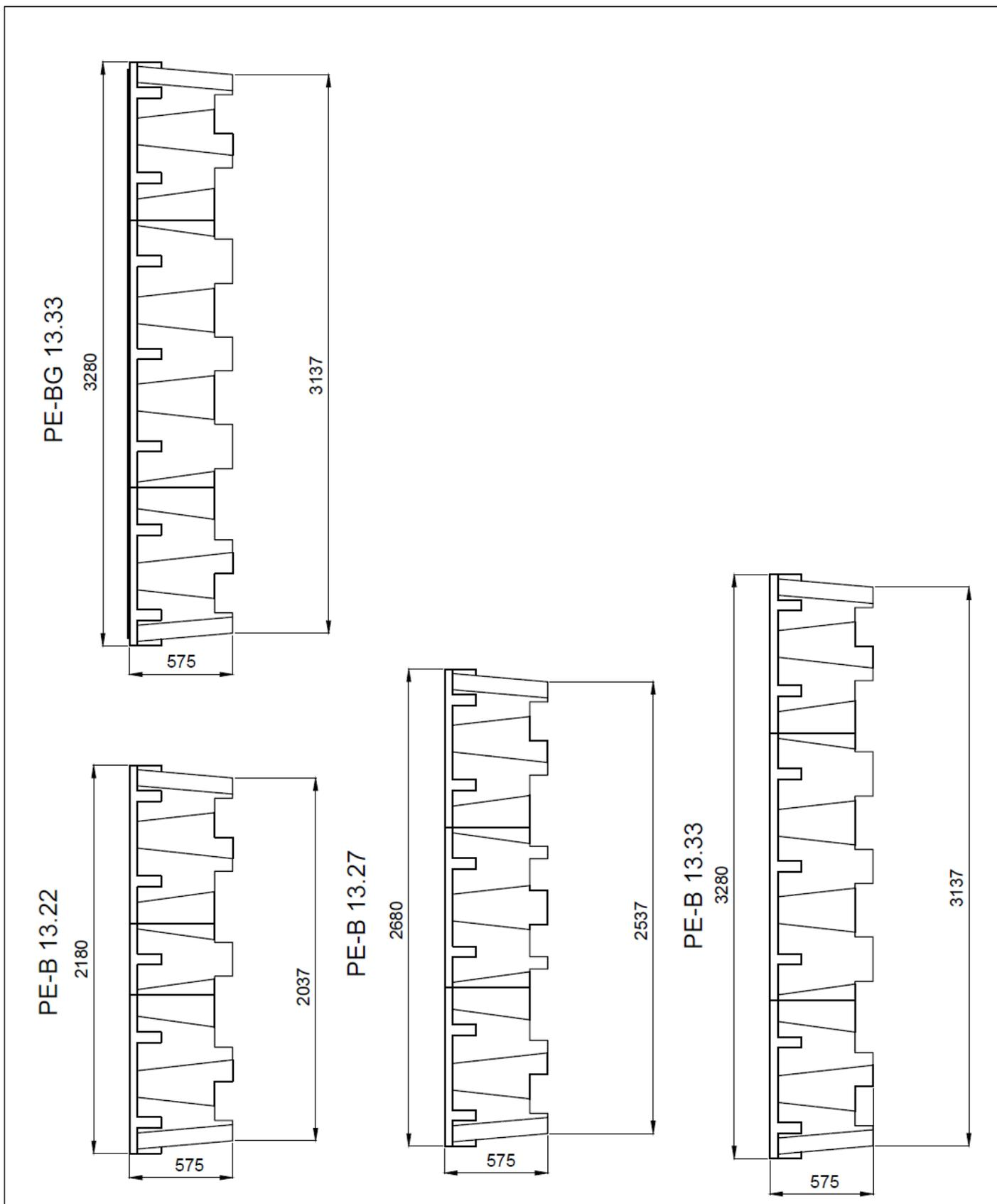
Rotationsgeformte Auffangvorrichtungen aus Polyethylen (PE)
