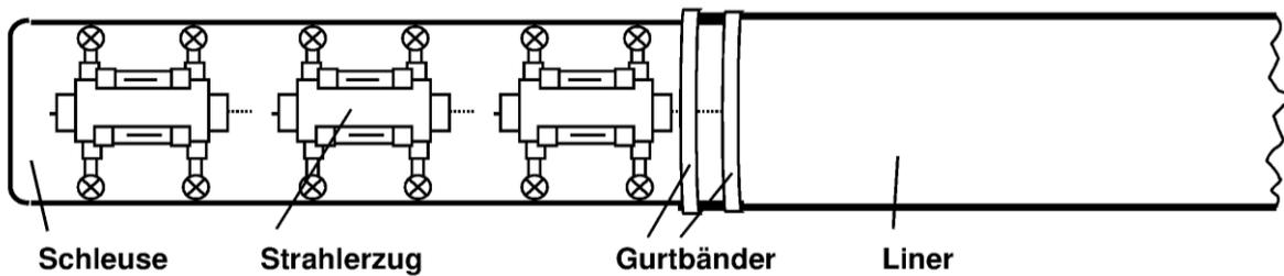
Als Schleuse kann ein Rohr oder Schlauch dienen, der mit dem Liner verbunden wird.
