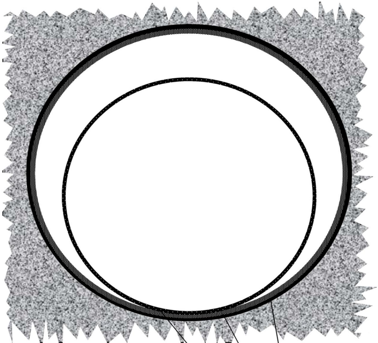
der Liner wird nach dem Einziehen mit Druckluft aufgestellt;
