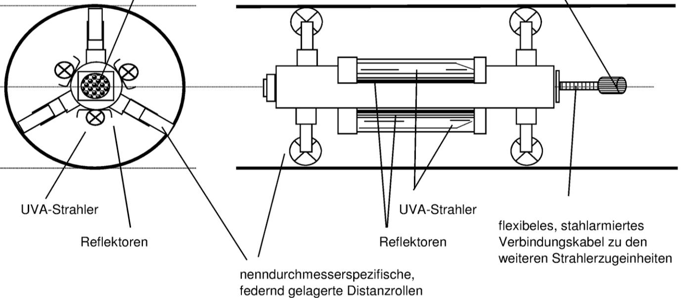
3 UVA-Strahler sind je Strahlerzugeinheit montiert;
