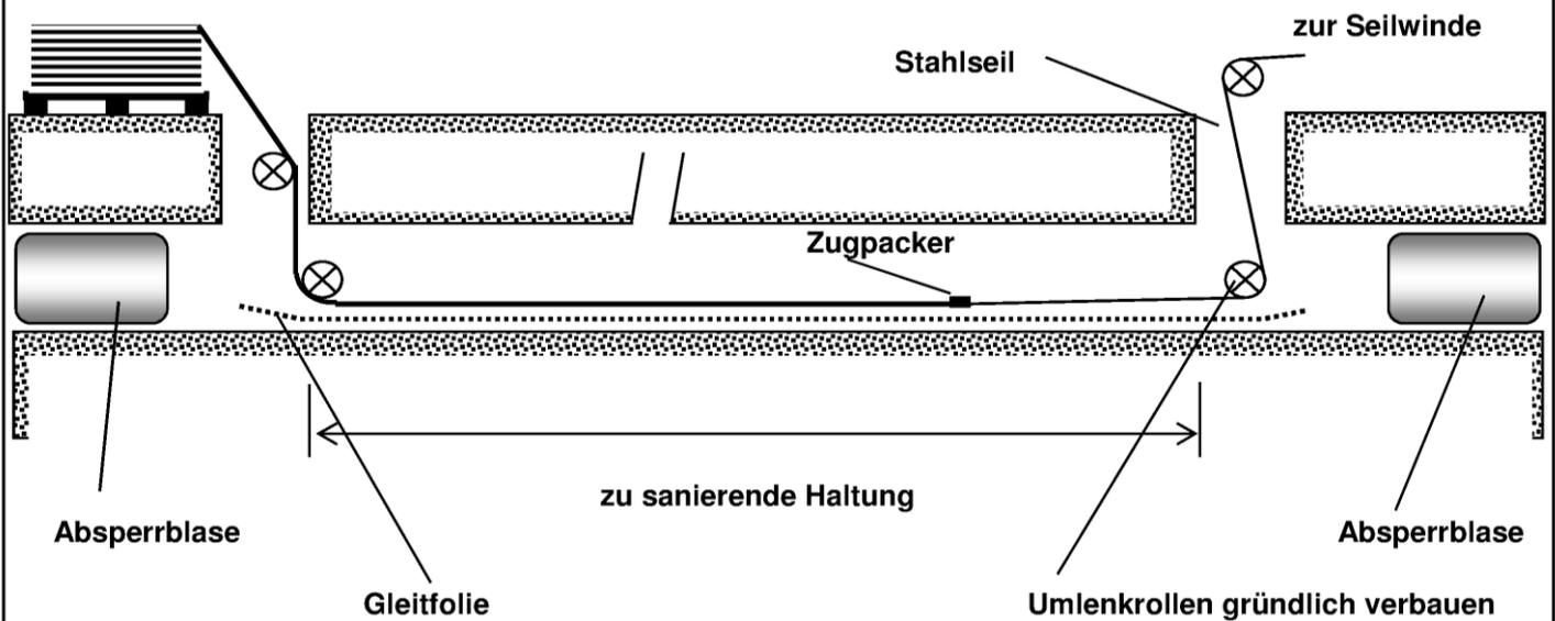
Schlauchlinierverfahren mit der Bezeichnung "Berolina Liner" und "Berolina HF Liner"
