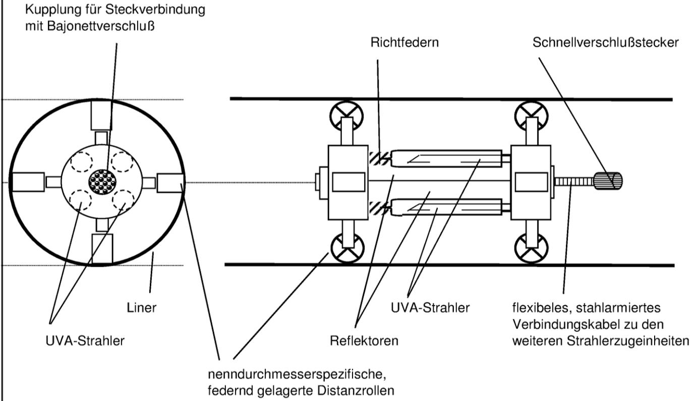
4 UVA-Strahler sind je Strahlerzugeinheit montiert;
