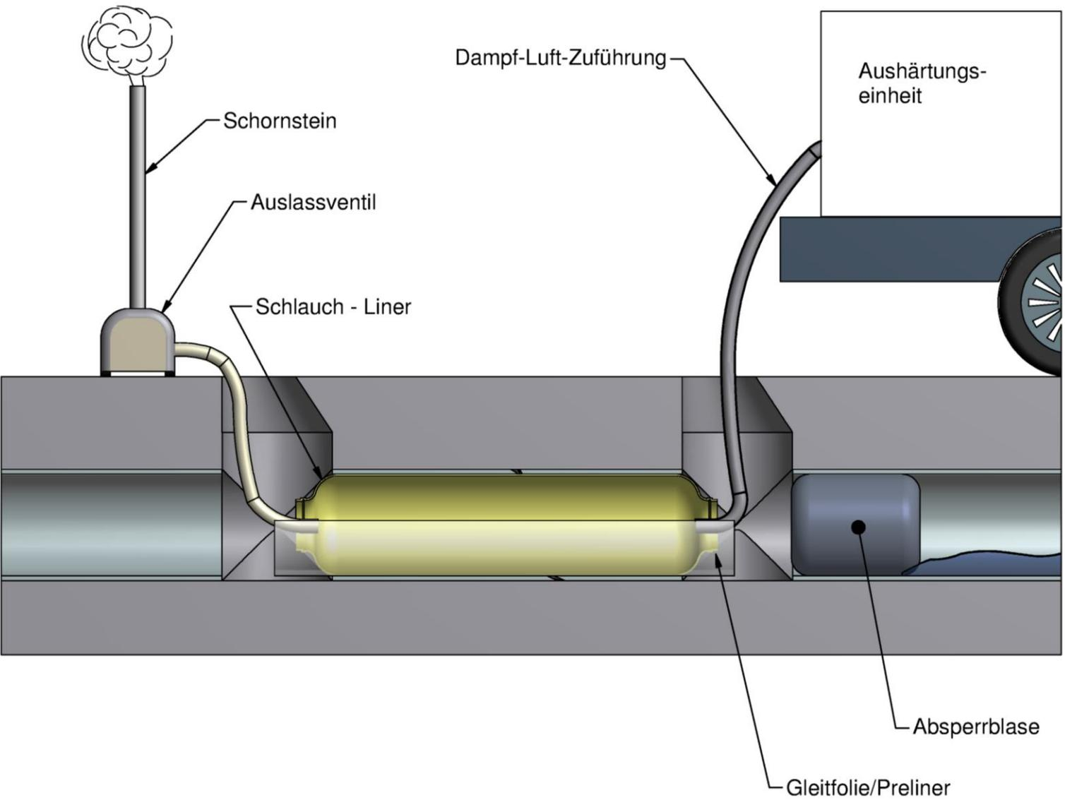
Schlauchliningverfahren zur Sanierung schadhafter erdverlegter Abwasserkanäle und -leitungen mit Ei- und Kreisprofilen mit den Bezeichnungen PAA-G-Liner und PAA-GF-Liner im Nennweitenbereich von DN 150 bis DN 1200, PAA-EG-Liner im Nennweitenbereich von DN 150 bis DN 600 und PAA-G3-Liner im Nennweitenbereich DN 100 bis 300
