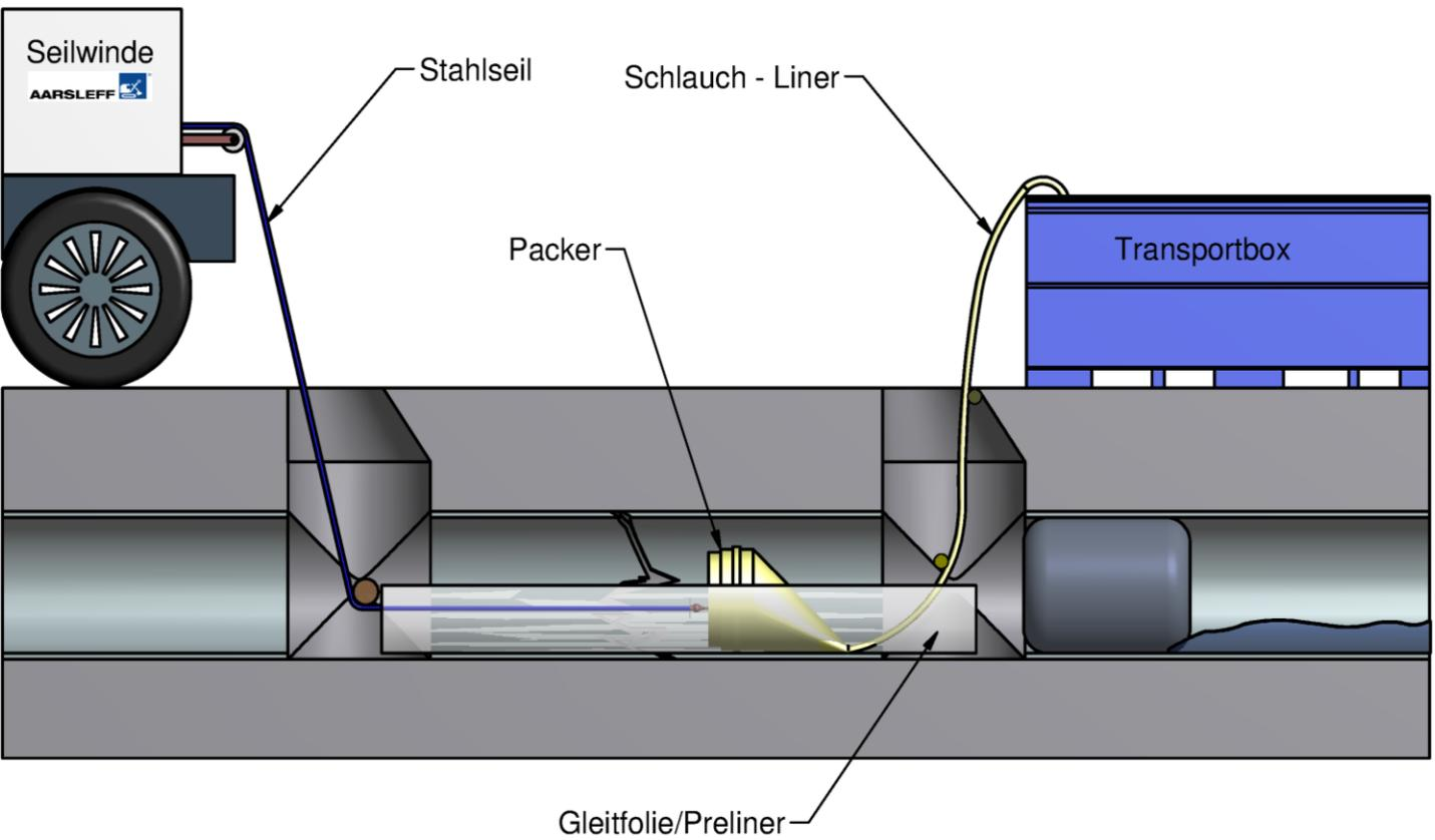
Schlauchliniungsverfahren zur Sanierung schadhafter erdverlegter Abwasserkanäle und -leitungen mit Ei- und Kreisprofilen mit den Bezeichnungen PAA-G-Liner und PAA-GF-Liner im Nennweitenbereich von DN 150 bis DN 1200, PAA-EG-Liner im Nennweitenbereich von DN 150 bis DN 600 und PAA-G3-Liner im Nennweitenbereich DN 100 bis 300
