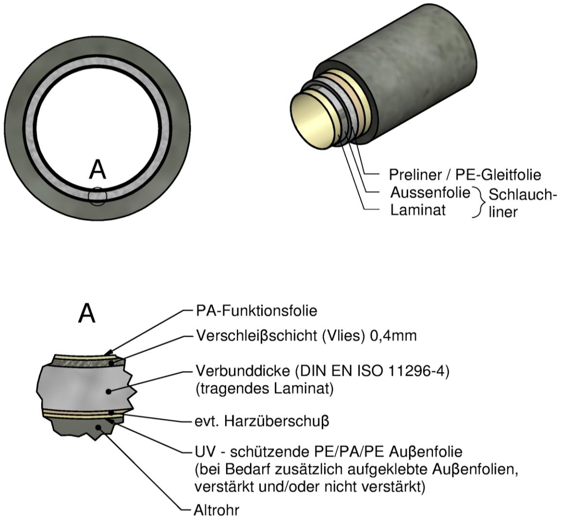
Schlauchliningverfahren zur Sanierung schadhafter erdverlegter Abwasserkanäle und -leitungen mit Ei- und Kreisprofilen mit den Bezeichnungen PAA-G-Liner und PAA-GF-Liner im Nennweitenbereich von DN 150 bis DN 1200, PAA-EG-Liner im Nennweitenbereich von DN 150 bis DN 600 und PAA-G3-Liner im Nennweitenbereich DN 100 bis 300
