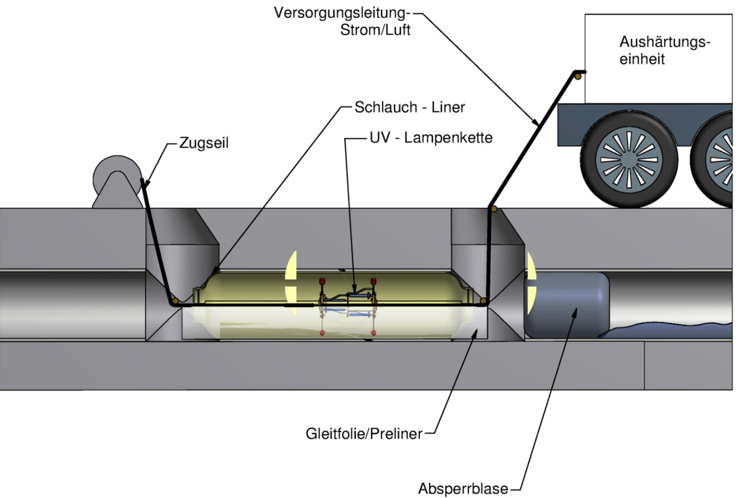
Schlauchliningverfahren zur Sanierung schadhafter erdverlegter Abwasserkanäle und- leitungen mit Ei- und Kreisprofilen mit den Bezeichnungen PAA-G-Liner und PAA-GF-Liner im Nennweitenbereich von DN 150 bis DN 1200, PAA-EG-Liner im Nennweitenbereich von DN 150 bis DN 600 und PAA-G3-Liner im Nennweitenbereich DN 100 bis 300
