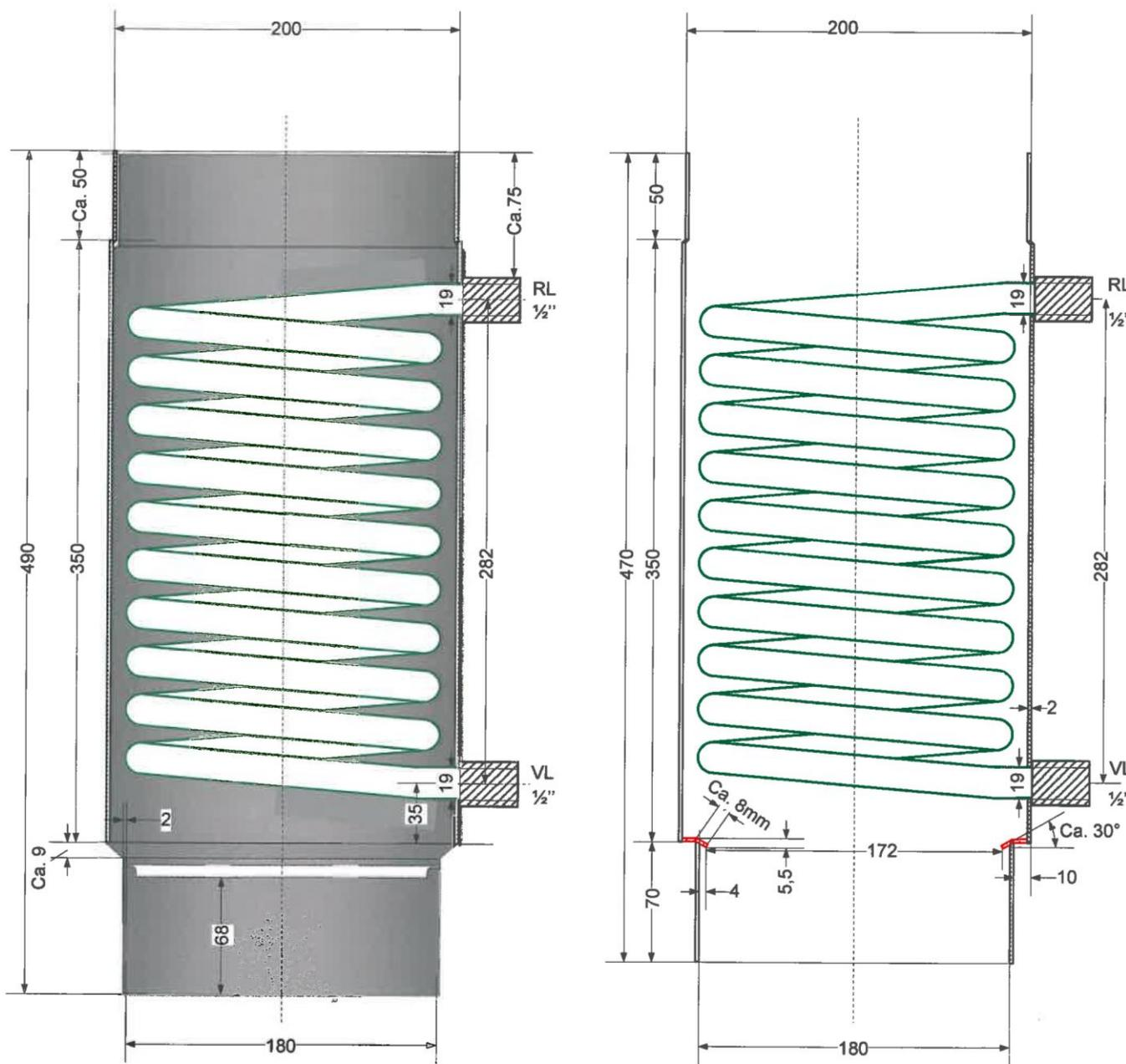
Rauchrohranschlüsse mit Kondensatring ausgeführt
