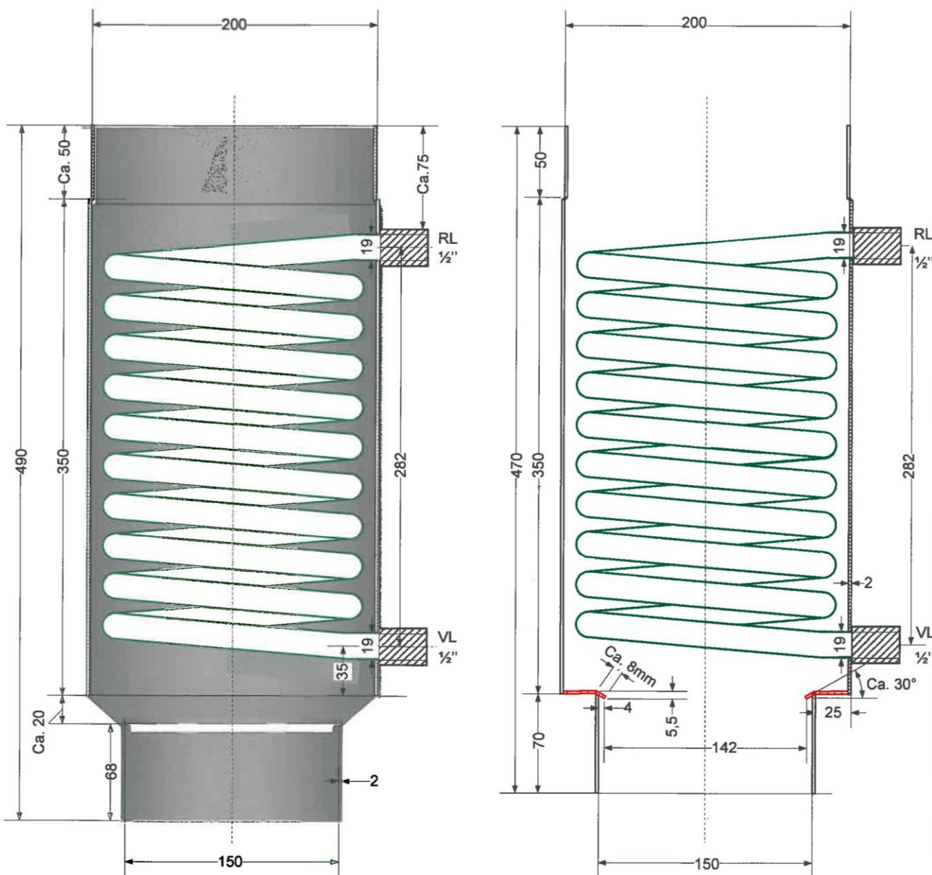
Rauchrohranschlüsse mit Kondensatring ausgeführt
