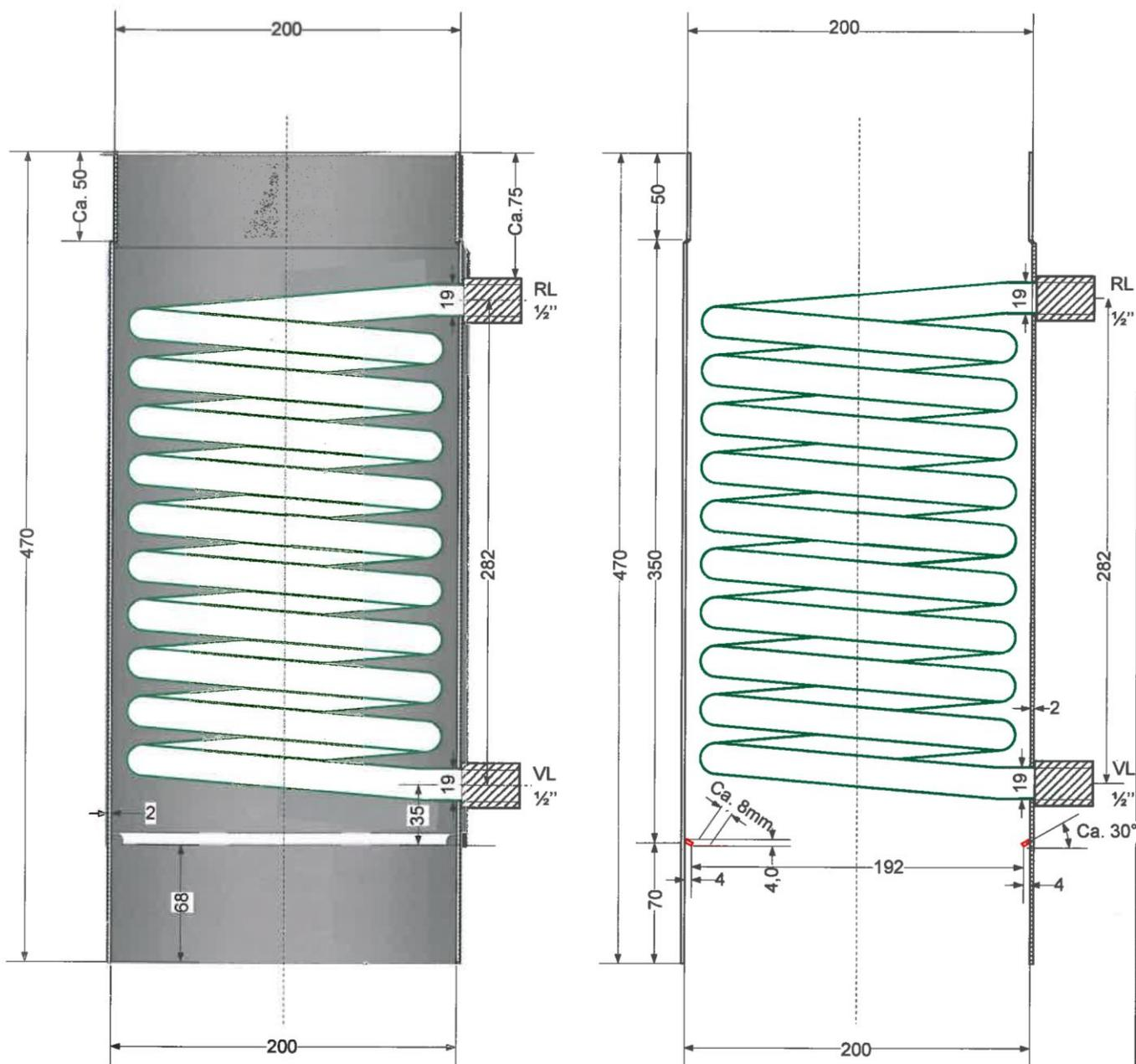
Rauchrohranschlüsse mit Kondensatring ausgeführt
