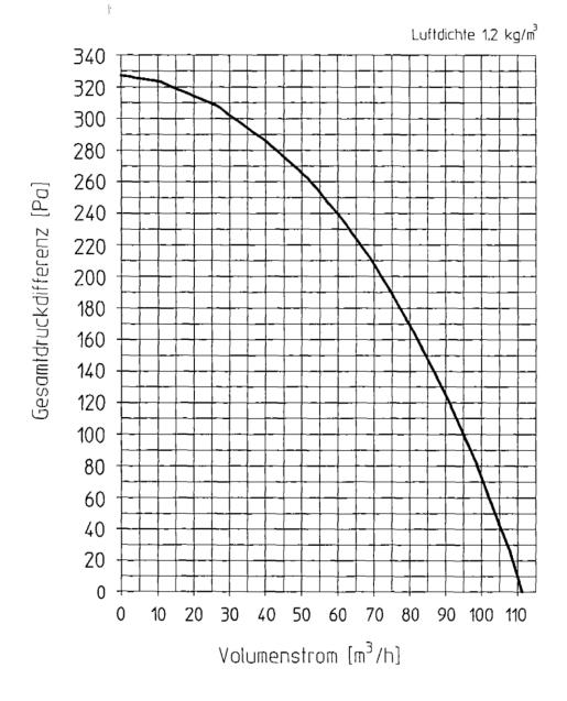
Einzelentlüftungsgeräte vom Typ ER 60/ER-UP, ER 100/ER-UP und ER 100/ER-UP mit Zweitraumabsaugung links, rechts oder unten zur Verwendung in
