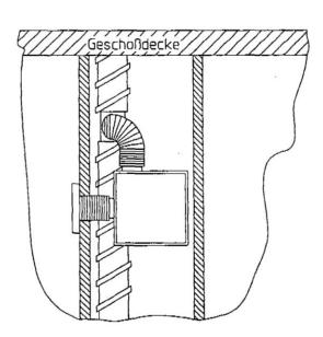
Einzelentlüftungsgeräte vom Typ ER 60/ER-UP, ER 100/ER-UP und ER 100/ER-UP mit Zweitraumabsaugung links, rechts oder unten zur Verwendung in
