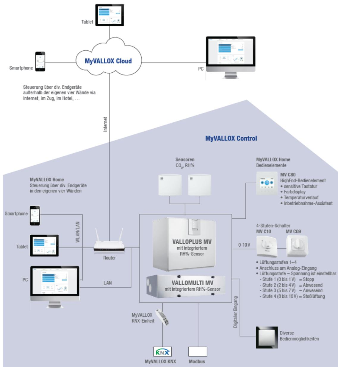
**Externe Bedienelemente der Steuerung des Gerätetyps "MV"**
