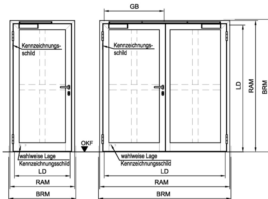
T 30-1-RS-FSA und T 30-2-RS-FSA immer mit unterer Bodendichtung ausführen und bei Wandanschluss immer beidseitig versiegeln!
