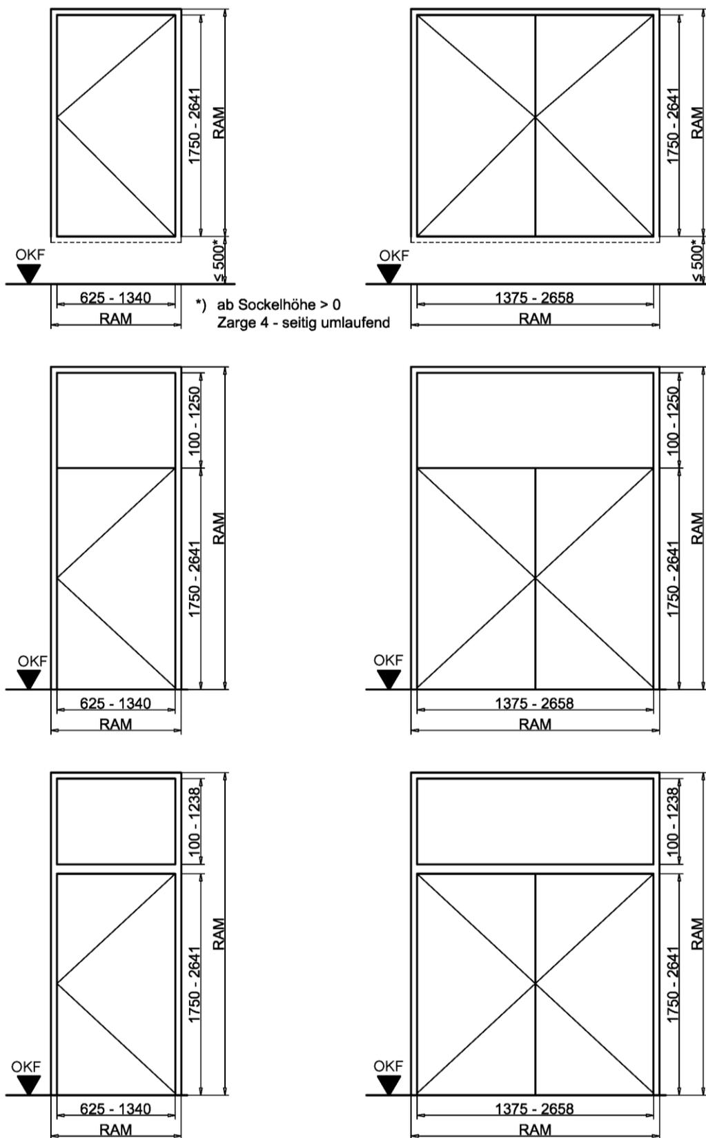
T 90-1-FSA "KF 63" bzw. T 90-1-RS-FSA "KF 63" bzw.
