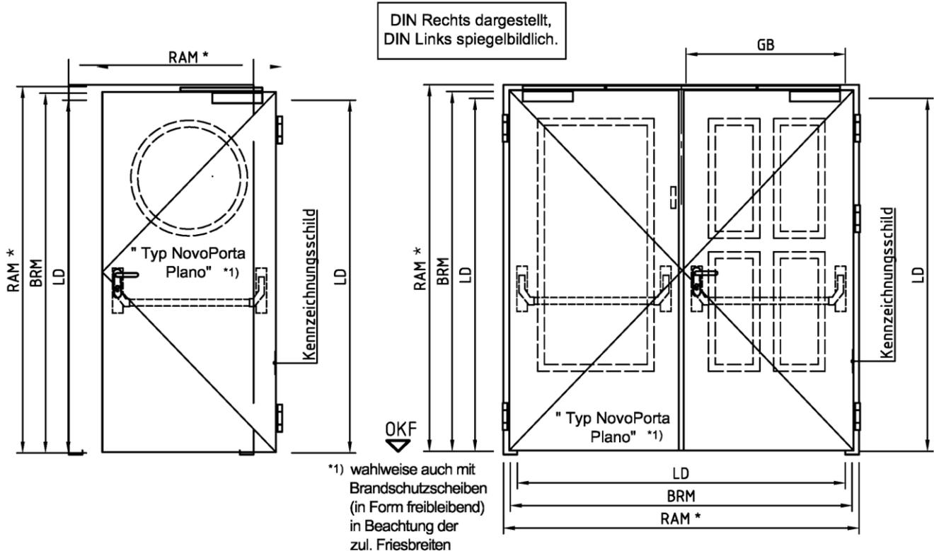
T 30-1-RS-FSA "Typ NovoPorta Plano" und T 30-2-RS-FSA "Typ NovoPorta Plano" immer mit zusätzlicher unterer Bodendichtung oder 4-seitige Dichtung ausführen. Bei Wandanschluss mit Mörtel hinterfüllung ohne Versiegelung ohne Versiegelung, ansonsten mindestens einseitig dauerelastisch versiegeln!
