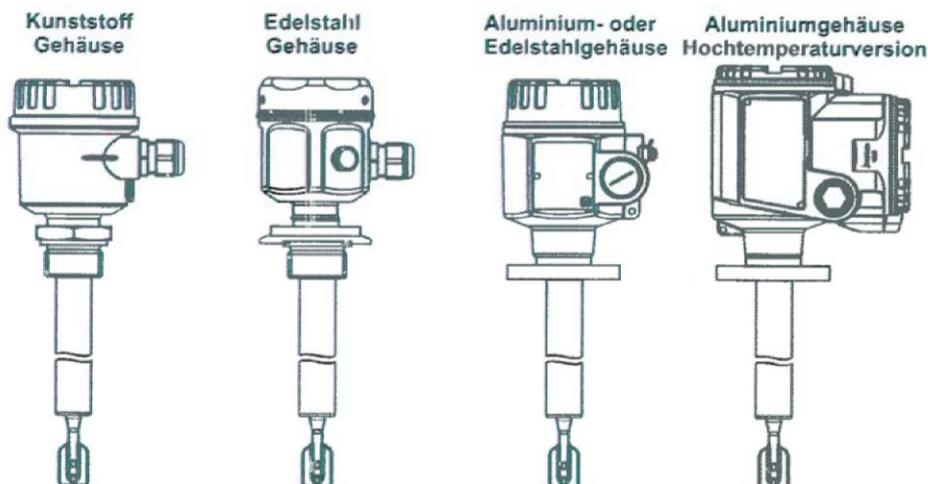
Schema der Überfüllsicherung für Messumformer FEL85
