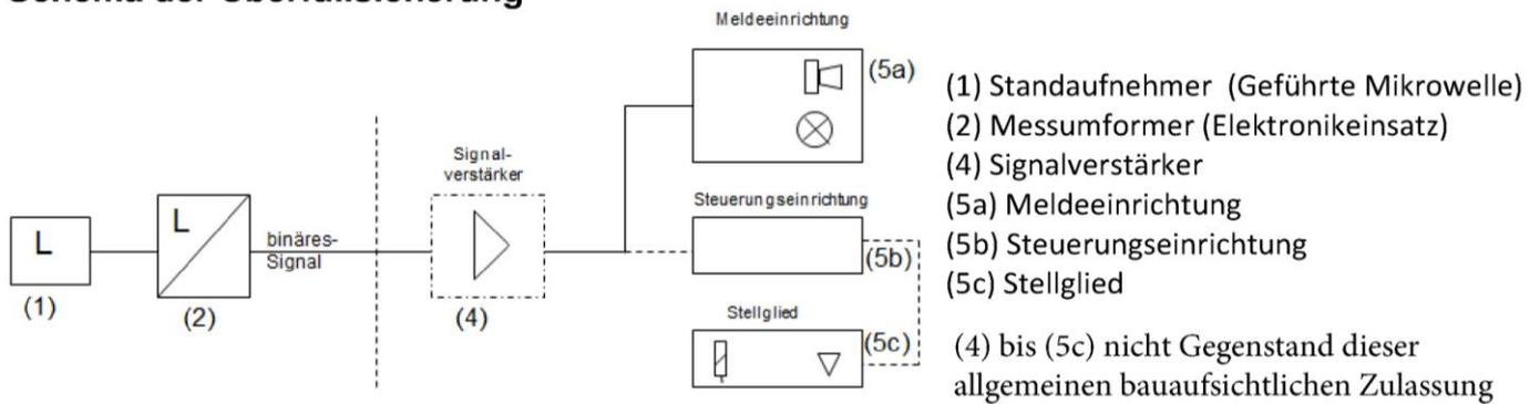
Standaufnehmer (TDR-Prinzip) Typ LFP....-G.WMA mit integriertem Messumformer als Teile von Überfüllsicherungen
