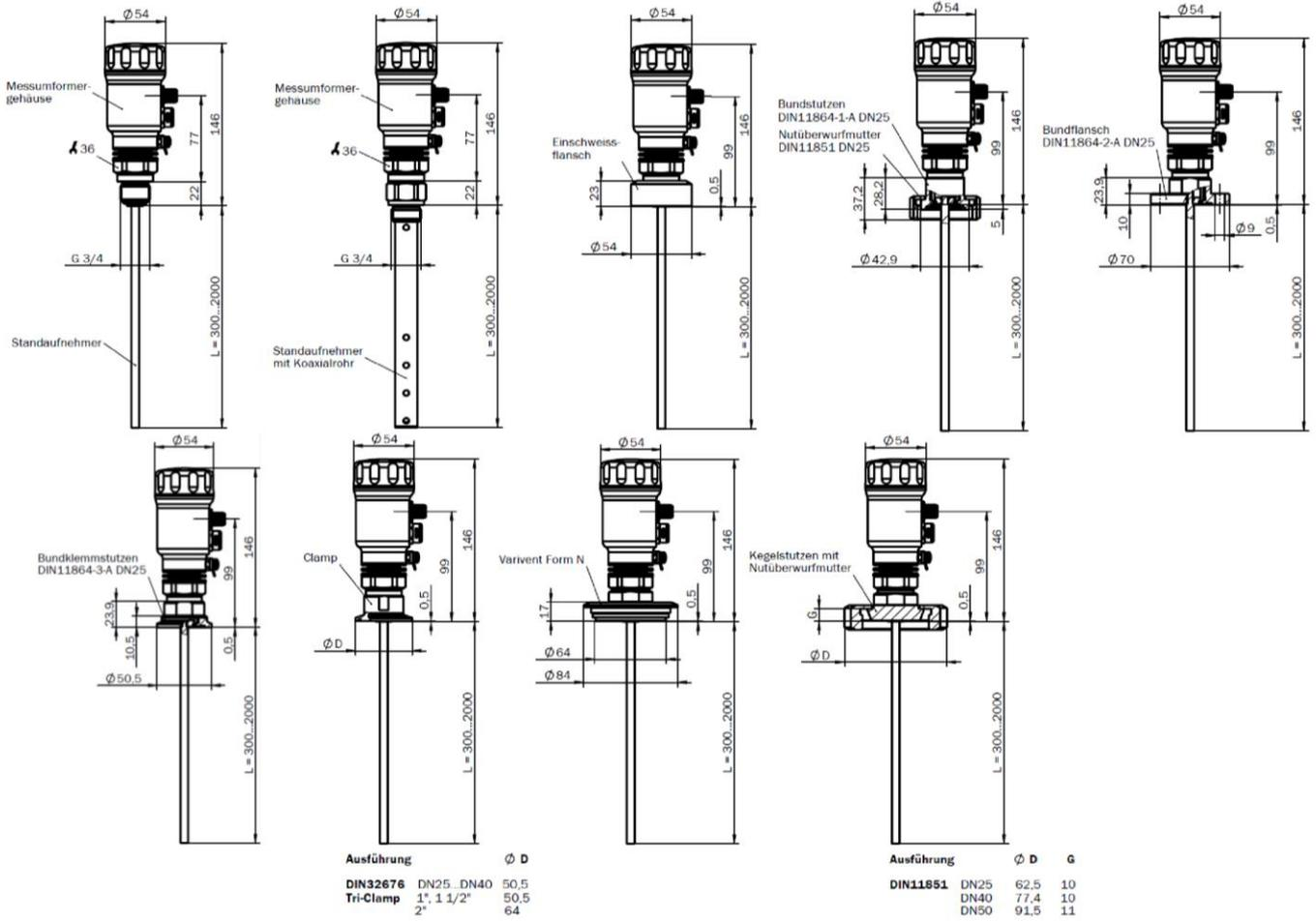
**Schema der Überfüllsicherung**
