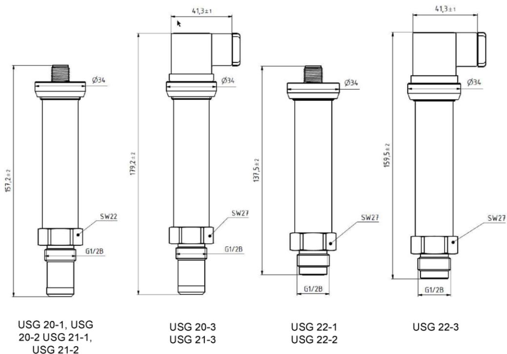
**Schema der Überfüllsicherung**
