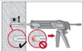
Injizieren des Mörtels vom Bohrlochgrund und während jedem Hub den Mischer langsam etwas herausziehen.
