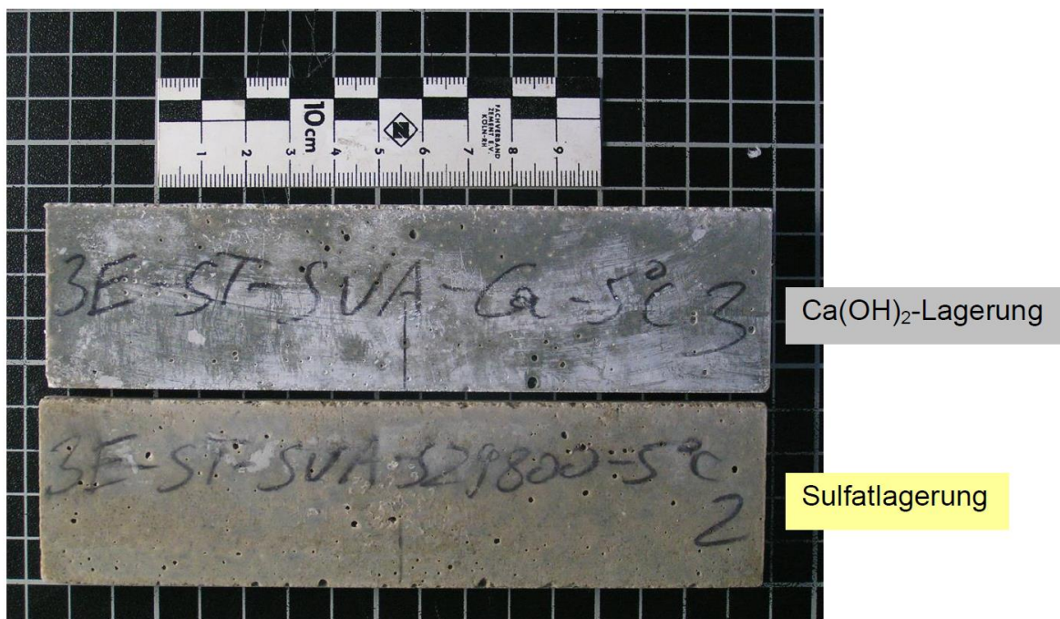
Bild A4: Probekörper aus CEM III/B 42,5 N-LH/SR nach 180 Tagen Lagerung: 5 °C in Ca(OH) 2 -Lösung (oben) und in Na 2 SO 4 -Lösung (unten)
