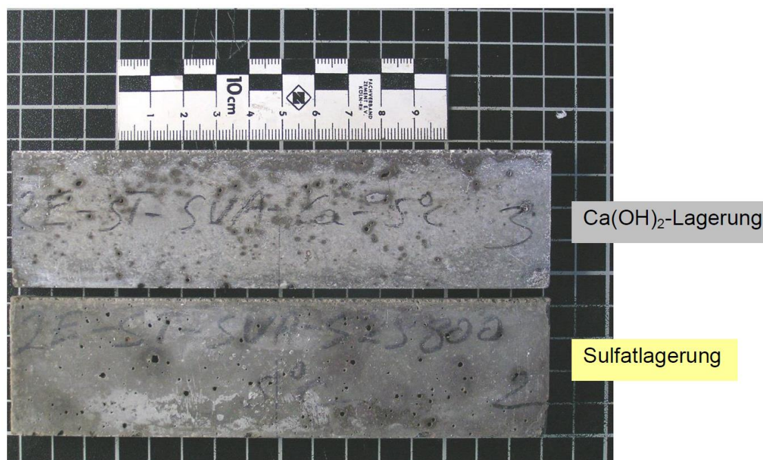
Bild A6: Probekörper aus CEM I 42,5 R-SR3 nach 180 Tagen Lagerung: 5 °C in Na 2 SO 4 -Lösung (oben) und in Ca(OH) 2 -Lösung (unten)
