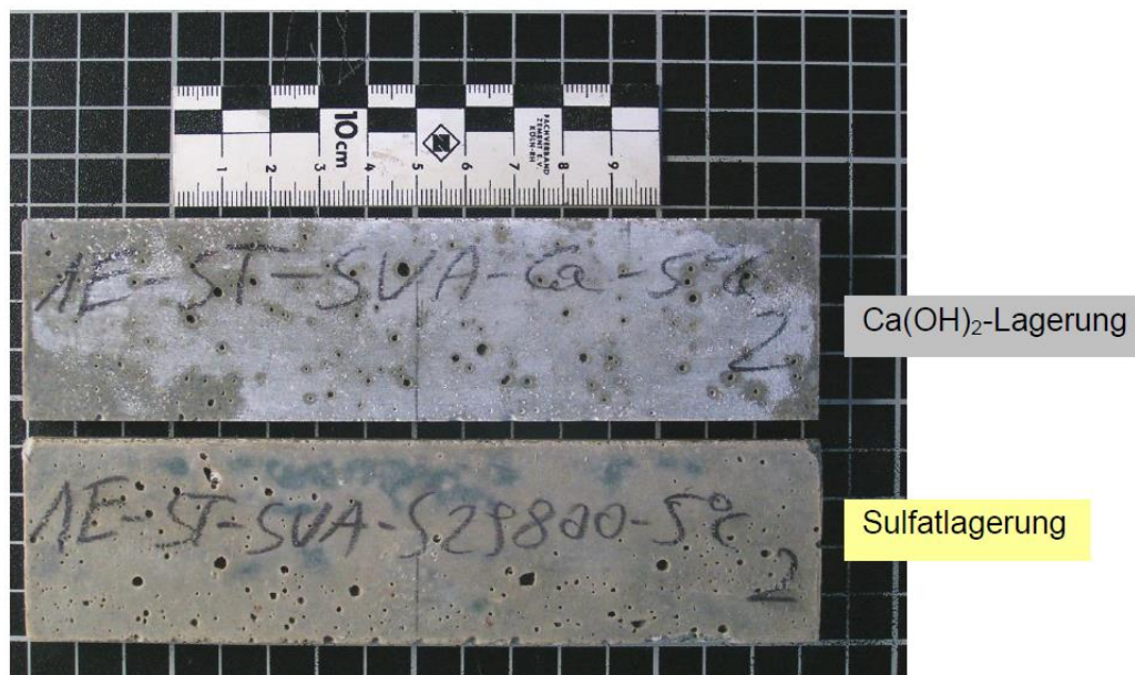
Bild A2: Probekörper aus CEM III/A 52,5 N-SR/LA "Dortmund" nach 180 Tagen Lagerung: 5 °C in \text{Ca}(\text{OH})_2 -Lösung (oben) und in \text{Na}_2\text{SO}_4 -Lösung (unten)
