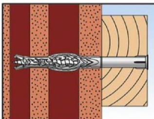
5. Richtig gesetzter Dübel in Hohlmauerwerk.
