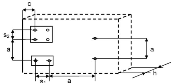
**Tabelle B4.2: Minimale Bauteildicke, Rand- und Achsabstände in Porenbeton (PB)**
