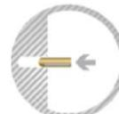
Ankerstange mit Hilfe eines Schlagbohrgerätes in das Bohrloch bis auf den Bohrlochgrund treiben. Aushärtezeiten laut Tabelle Reaktionszeiten beachten. Bei feuchtem Untergrund ist die Aushärtezeit zu verdoppeln.
