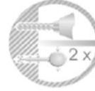
Anschließend zweimal mit der Bürste RBS und erneut mit dem Ausbläser AB reinigen.
