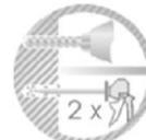
Reinigung des Bohrlochs:
