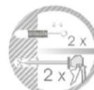
Patrone auf Einsatzfähigkeit prüfen. Patrone darf nicht beschädigt sein, Harz muss zähflüssig fließen. Patrone in das Bohrloch einführen.
