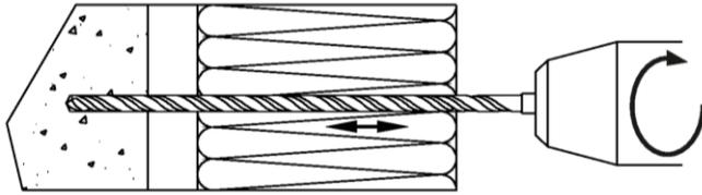
1) Bohrloch senkrecht zur Oberfläche erstellen.
