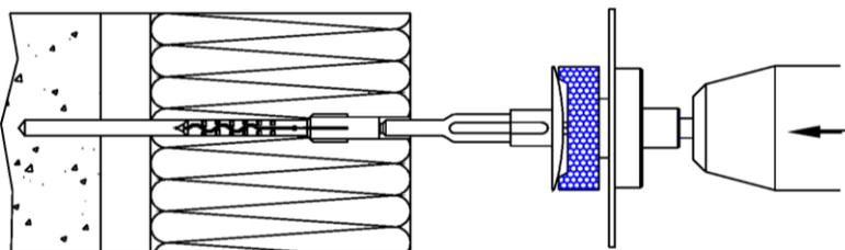
3) Dübel in das Bohrloch durch den Dämmstoff bis der Haltetellers auf dem Dämmstoff aufliegt einsetzen.
