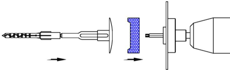
2) Rondelle und Dübel auf das Montagetool setzen.
