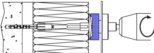
4) Dübel mit Schraubgerät bis die Anschlagsscheibe auf dem Dämmstoff anliegt einschrauben.
