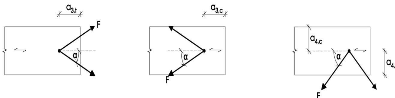
Abbildung A.2.1 Definition der Mindestabstände in der Seitenfläche
