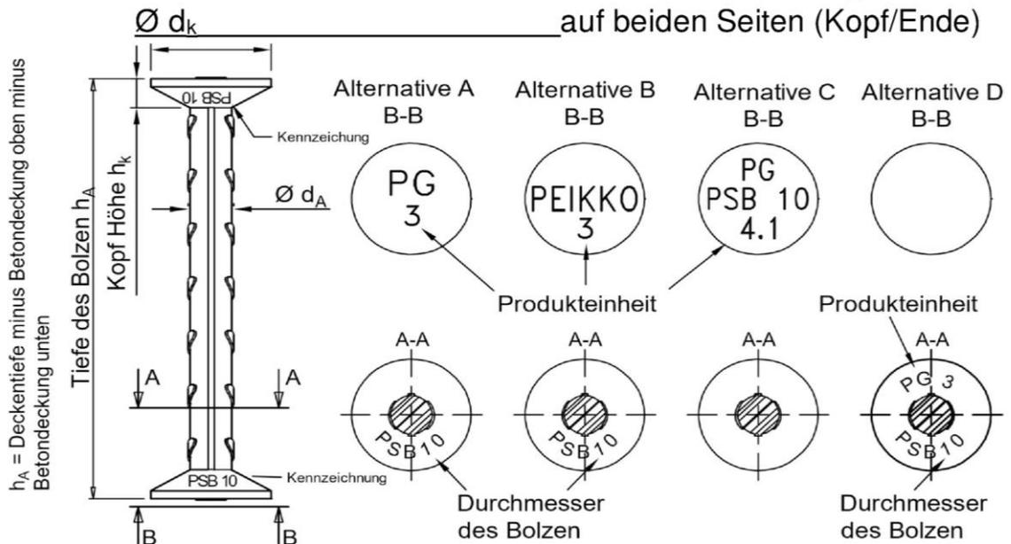
Material: Betonstahl mit charakteristischer Streckgrenze  $f_{yk} \geq 500$  MPa gemäß EN 1992-1-1 Anhang C und Datenblatt hinterlegt bei DIBt
