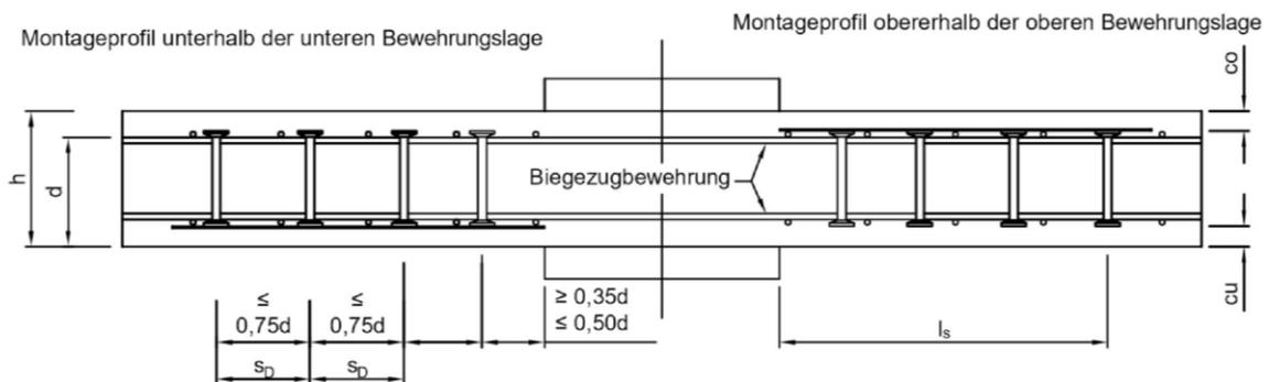
Betondeckung  $c_o$  bzw.  $c_u$  gemäß EN 1992-1-1:2004, Abschnitt 4
