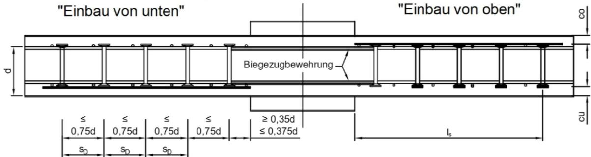
Betongdeckung  $c_o$  bzw.  $c_u$  gemäß EN 1992-1-1:2004, Abschnitt 4
