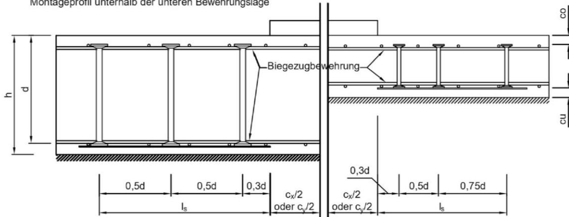
Betondeckung  $c_o$  bzw.  $c_u$  gemäß EN 1992-1-1:2004, Abschnitt 4
