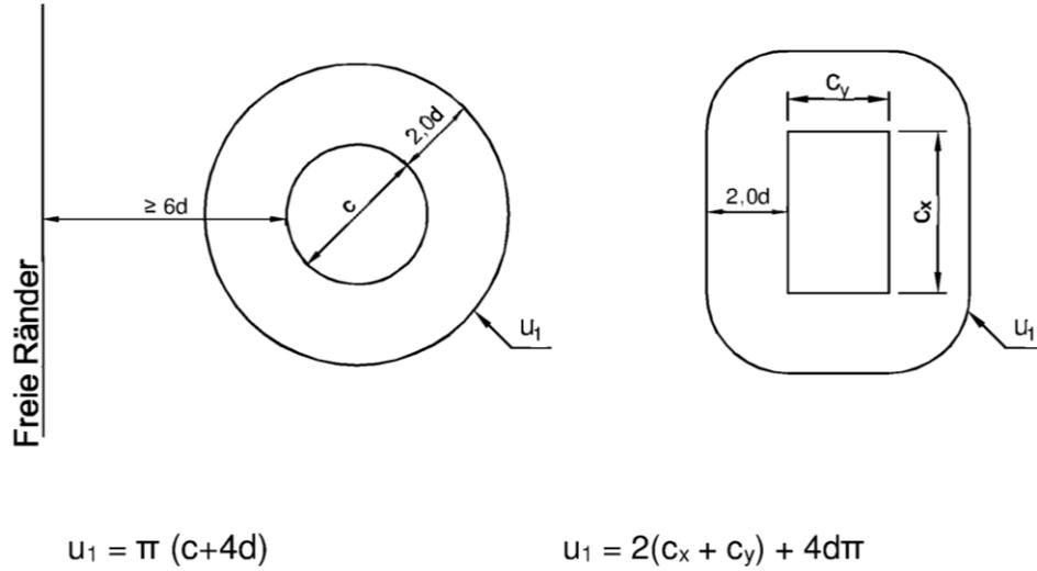
b) Belastete Fläche (Stütze) liegt weniger als  $6d$  von Plattenöffnung (Ausparung) entfernt.
