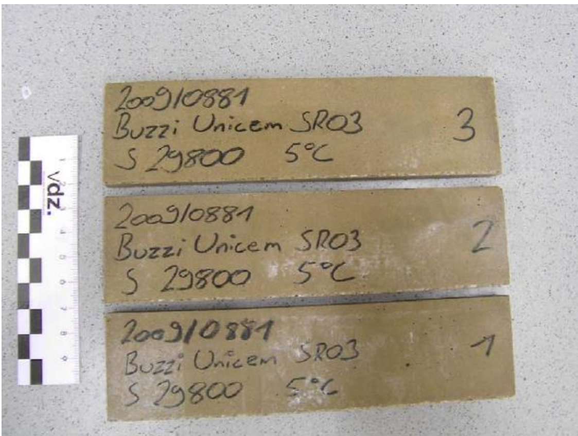
Bild A2.4: Probekörper aus Zement auf Calciumsulfoaluminatbasis "Next Base SR03" nach 90 Tagen; Lagerung: 5 °C in \text{Ca(OH)}_2 -Lösung
