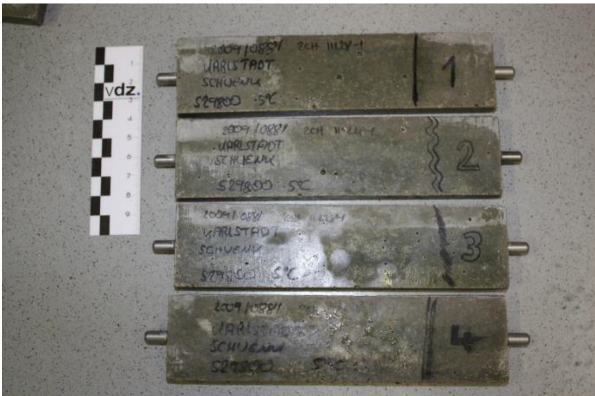
Bild A2.8: Probekörper aus CEM I 42,5 R-SR3 nach 90 Tagen; Lagerung: 5 °C in Na 2 O 4 -Lösung
