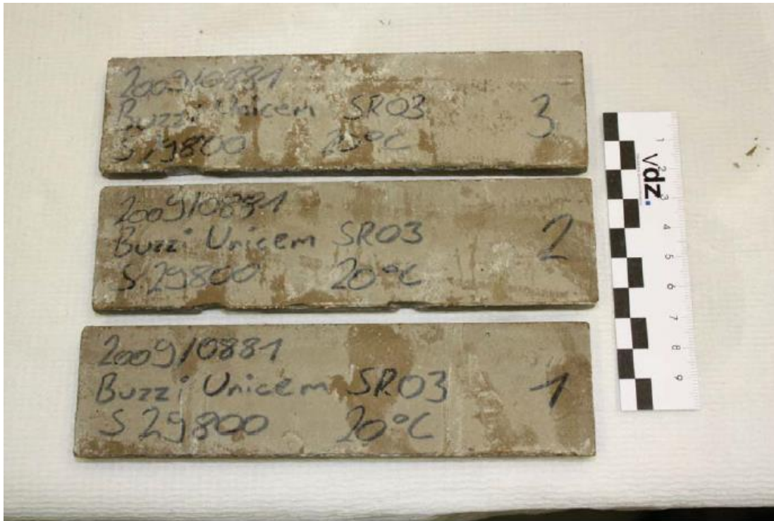
Bild A2.3: Probekörper aus Zement auf Calciumsulfoaluminatbasis "Next Base SR03" nach 180 Tagen; Lagerung: 20 °C in \text{Ca(OH)}_2 -Lösung
