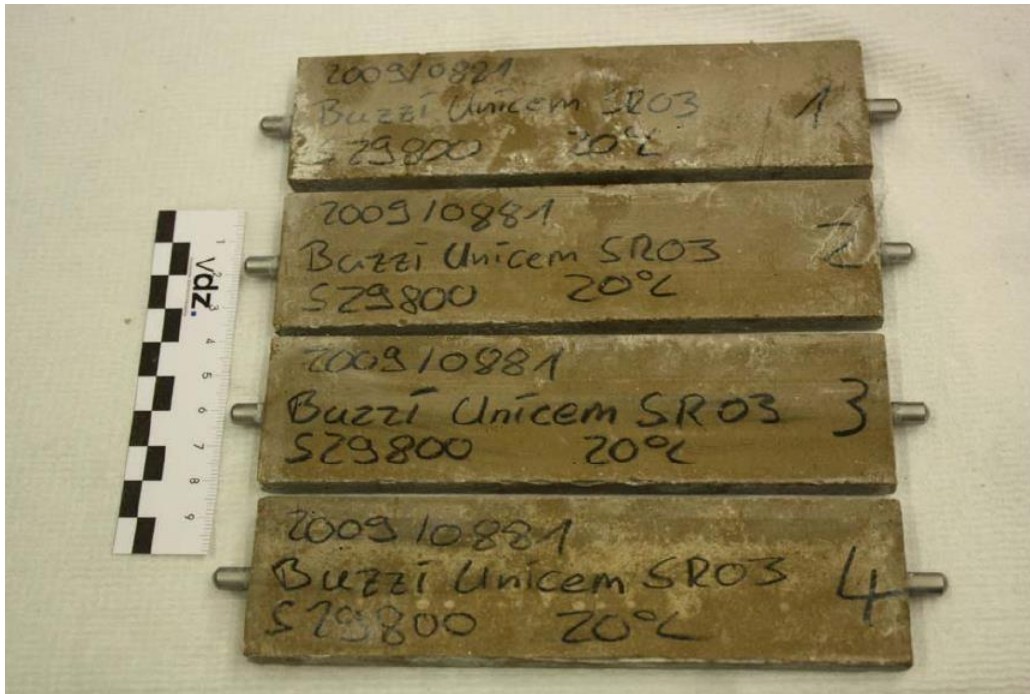
Bild A2.1: Probekörper aus Zement auf Calciumsulfoaluminatbasis "Next Base SR03" nach 180 Tagen; Lagerung: 20 °C in \text{Na}_2\text{O}_4 -Lösung
