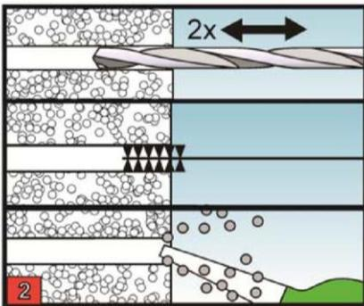
Das Bohrmehl ist aus dem Bohrloch zu entfernen
