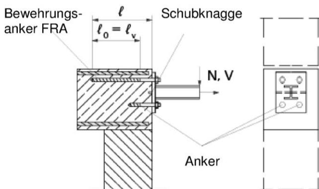
**Bild A8:** Übergreifungsstoß für die Verankerung von ausragenden Bauteilen. In der Ankerplatte sind für den Bewehrungsanker FRA die Bohrlöcher als Langlöcher mit Achse in Richtung der Querkraft auszuführen.
