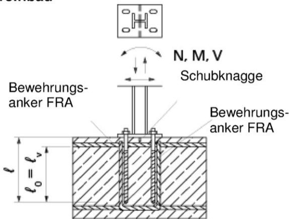
**Bild A6:** Übergreifungsstoß einer biegebeanspruchten Stütze an ein Fundament.
