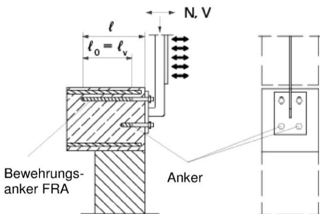
**Bild A7:** Übergreifungsstoß für die Verankerung von Geländerpfosten. In der Ankerplatte sind für den Bewehrungsanker FRA die Bohrlöcher als Langlöcher mit Achse in Richtung der Querkraft auszuführen.
