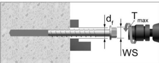
Eindreihen der Schraube mittels Drehmomentenschlüssel
