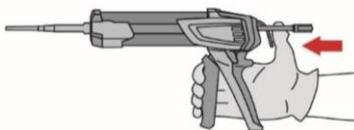
Nach der Mörtelinjektion die Entriegelungstaste am Auspressgerät betätigen, um Mörtelnachlauf zu vermeiden.
