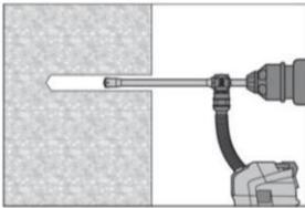
Die Bohrerherstellung bis zur erforderlichen Setztiefe erfolgt dreh Schlagend mit einem Hilti Hohlbohrer TE-CD oder TE-YD mit angeschlossenem Staubsauger. Dieses Bohrsystem beseitigt bei Anwendung gemäß der Gebrauchsanweisung des Hohlbohrers das Bohrmehl und reinigt das Bohrloch während des Bohrvorgangs.
