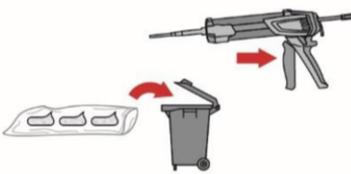
Das Öffnen der Foliengebinde erfolgt automatisch bei Auspressbeginn. Der am Anfang aus dem Mischer austretende Mörtelvorlauf darf nicht für Befestigungen verwendet werden. Die Menge des Mörtelvorlaufes ist abhängig von der Gebindegröße:
