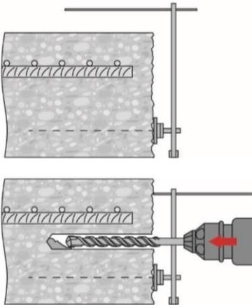
Sichergestellt, dass das Bohrloch parallel zur bestehenden Bewehrung ist.
