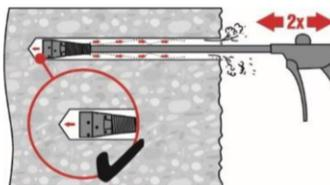
Die passende Luftdüse Hilti HIT-DL ist zu verwenden (siehe Table B4). Bohrloch 2-mal vom Bohrlochgrund über die gesamte Länge mit ölfreier Druckluft ausblasen, bis die rückströmende Luft staubfrei ist
