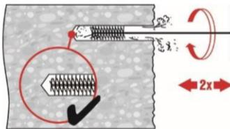
2-mal mit Stahlbürste in passender Größe (siehe Tabelle B4) bürsten. Stahlbürste Hilti HIT-RB mit einer Drehbewegung in das Bohrloch bis zum Bohrlochgrund einführen und wieder herausziehen (falls notwendig mit Verlängerung).
