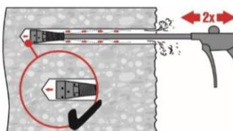
Die passende Luftdüse Hilti HIT-DL ist zu verwenden (siehe Table B4). Bohrloch 2-mal vom Bohrlochgrund über die gesamte Länge mit ölfreier Druckluft ausblasen, bis die rückströmende Luft staubfrei ist
