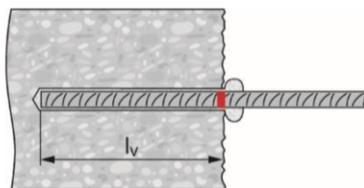
Nach dem Setzen des Betonstahls muss der Ringspalt vollständig mit Mörtel ausgefüllt sein.
