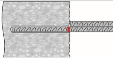
Beachten der Verarbeitungszeit  $t_{work}$  (siehe Tabelle B3), die je nach Untergrundtemperatur unterschiedlich sein kann. Während der Verarbeitungszeit ist ein geringfügiges Ausrichten des Betonstahls möglich.
