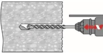
Bohrloch mit Bohrhammer dreh Schlagend, unter Verwendung des passenden Bohrerdurchmessers auf die richtige Bohrtiefe erstellen.
