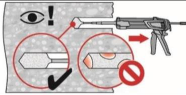
Injizieren des Mörtels vom Bohrlochgrund und während jedem Hub den Mischer langsam etwas herausziehen.
