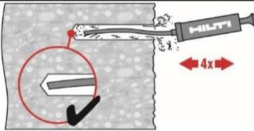
Für Bohrlochdurchmesser  $d_0 \leq 20$  mm und Bohrlöchtiefen  $h_{er} \leq 10 \cdot d$  kann die Hilti Handausblaspumpe verwendet werden.
