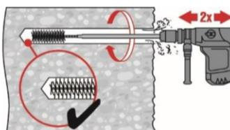
Rundbürste Hilti HIT-RB auf Verlängerung Hilti HIT-RBS aufschrauben. Verlängerung(en) bis zur entsprechenden Bohrlochtiefe durch Zusammenschrauben verlängern, sodass sichergestellt ist, dass das Bohrlochende erreicht wird. TE-C / TE-Y Einsteckende auf die Verlängerung schrauben und im Bohrfutter befestigen.
