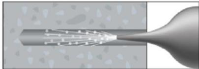
2. Bohrloch vom Bohrmehl reinigen
