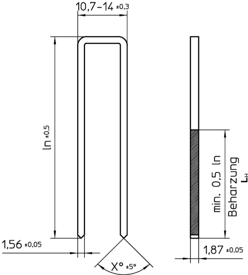
Klammerndraht  $d = \varnothing 1,78 \pm 0,03$
