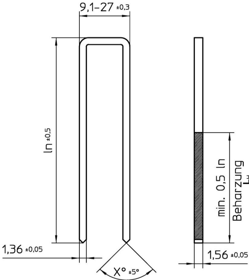
Klammerndraht  $d = \varnothing 1,51 \pm 0,03$
