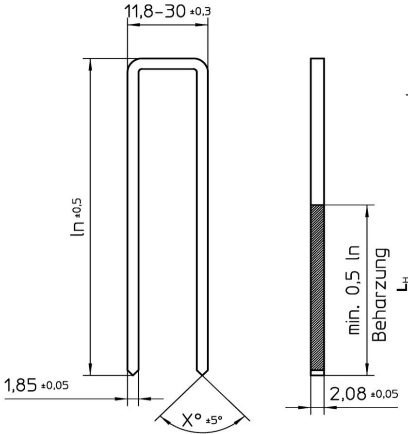
Klammerndraht  $d = \varnothing 2,0 \pm 0,03$
