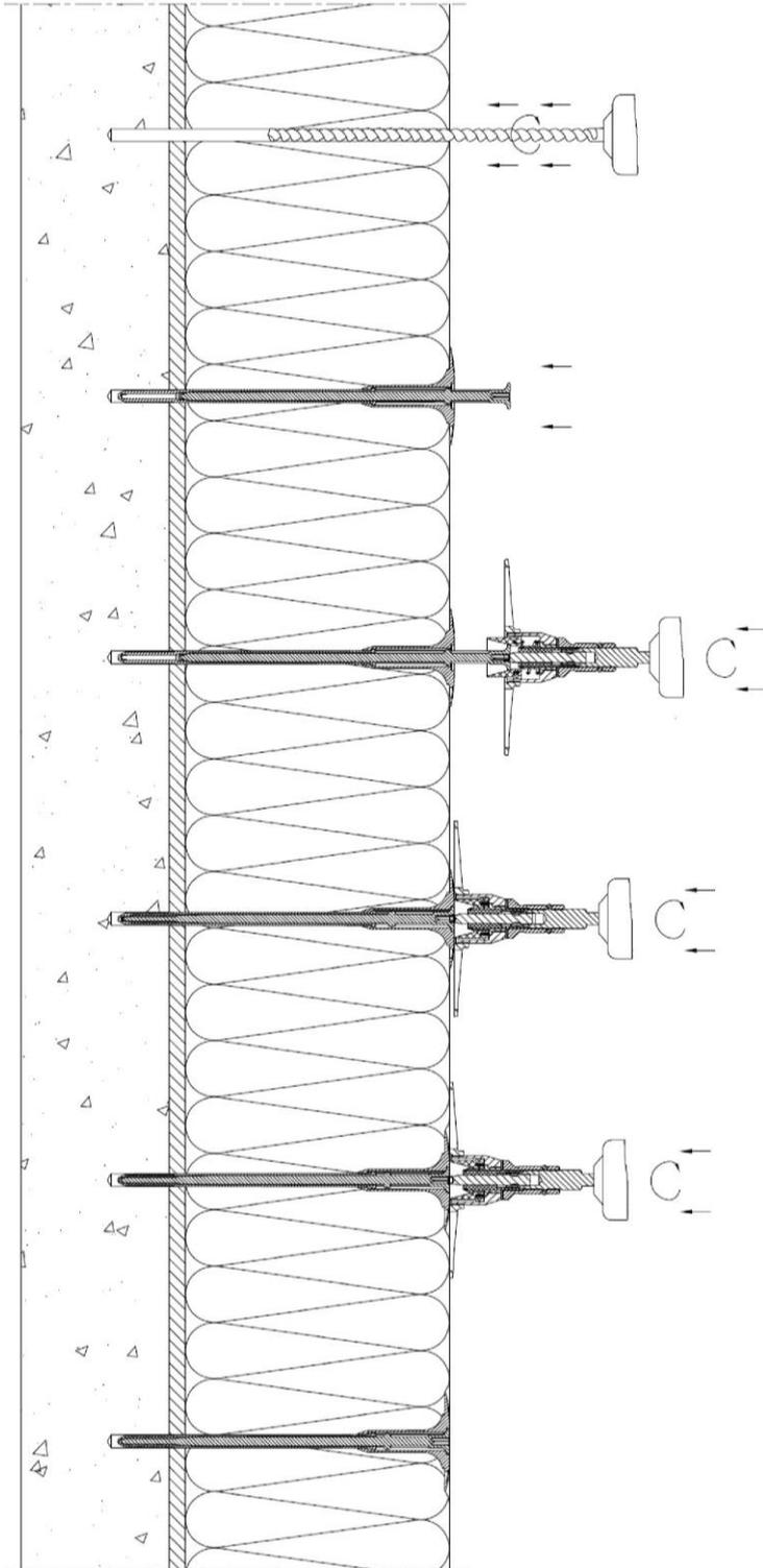
Bohrloch senkrecht zur Oberfläche
