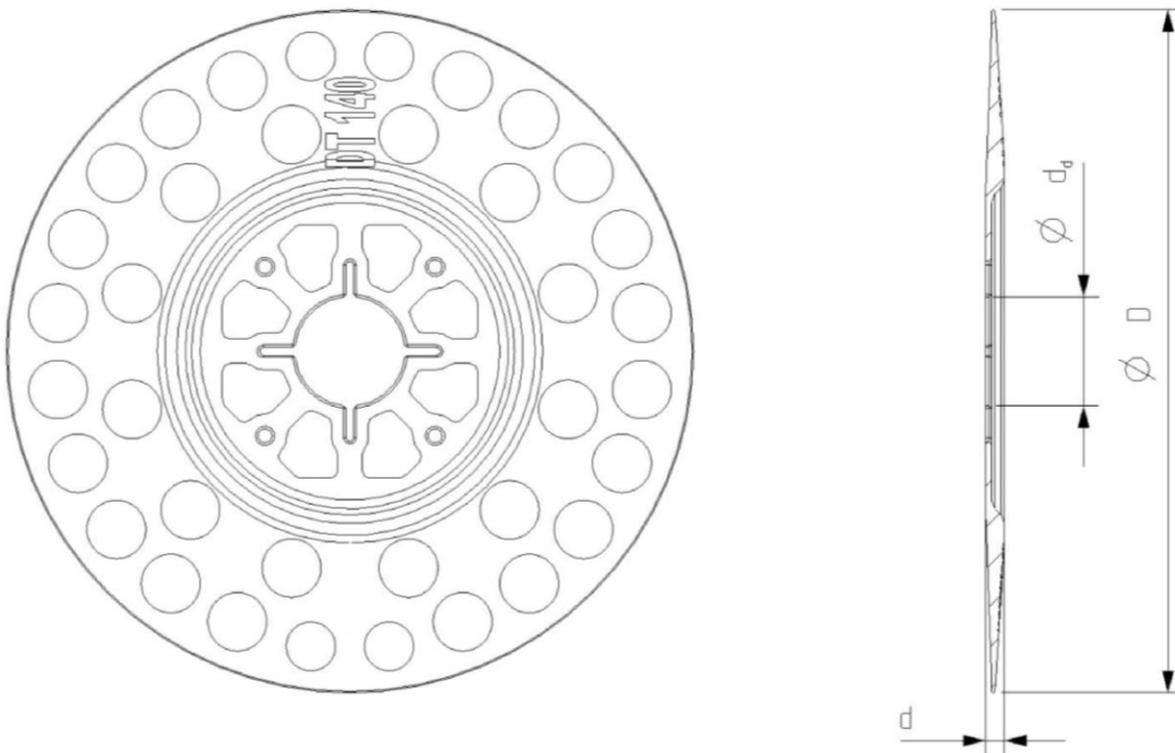
**Tabelle A3.2 Dübelteller, Abmessungen und Werkstoff**
