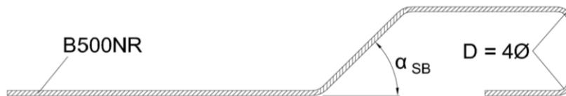
c) Ausführung nichtrostender Betonstahl B500 NR, oberer Querkraftstabschenkel als Schlaufe
