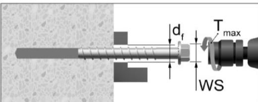
Eindreihen der Schraube mittels Drehmomentenschlüssel
