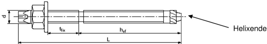
**- Ankerstangen Chemset™ M8 bis M16 mit Mutter und Scheibe (A4)**
