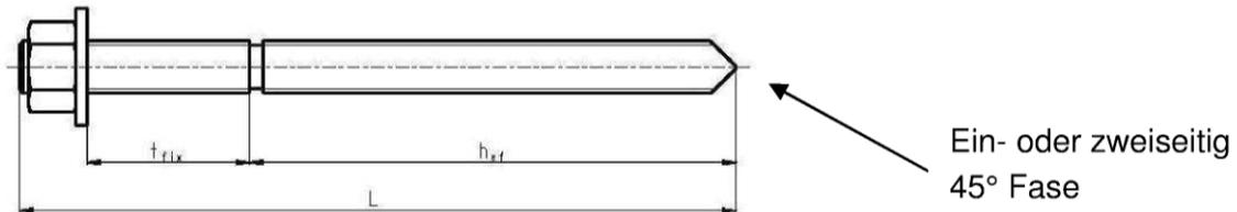
Markierung auf der Ankerstange Chemset™: Buchstabe S, Gewindegröße und maximale Anbauteildicke: z.B.: S M10 / 20
