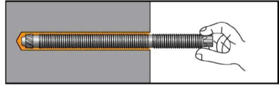
**7** Stahlteil nicht berühren während der Aushärtezeit gemäß Tabelle B7 oder B8. Anschließend Montage des Anbauteils und Aufbringen des Montagedrehmoments gemäß Anhang B3 oder B4.
