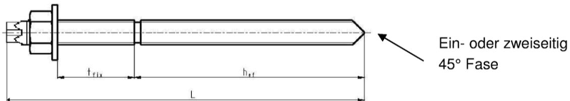
**- Ankerstangen Chemset™ M20 bis M30 mit Mutter und Scheibe (Galvanisch verzinkt / A4)**
