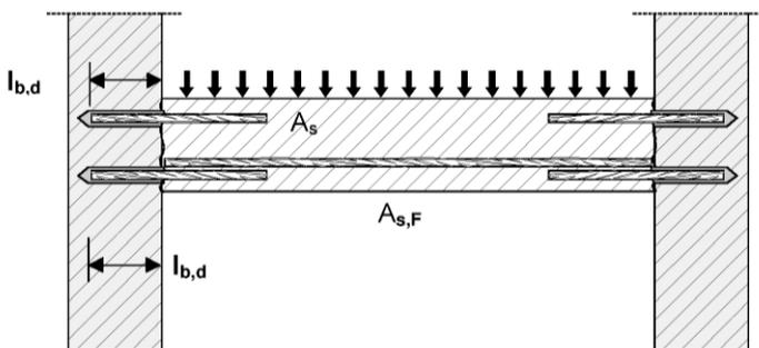
**Bild A3:** Endverankerung von Platten oder Balken
