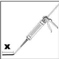
5. Der Mörtelvorlauf ist nicht zur Befestigung des Bewehrungsseisens geeignet. Daher Vorlauf solange verwerfen, bis sich eine gleichmäßig graue Mischfarbe eingestellt hat, jedoch min. 3 volle Hübe.
