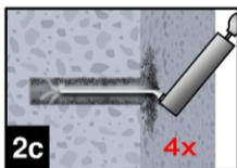
2c. Abschließend das Bohrloch erneut vom Bohrlochgrund her 4x vollständig mit Druckluft (min. 6 bar) (Annex B 7) ausblasen, bis die ausströmende Luft staubfrei ist. Bei tiefen Bohrlochern sind geeignete Verlängerungen zu verwenden.
