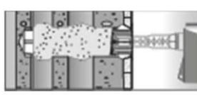
Die Injektions-Ankerhülse vollständig vom Grund des Bohrlochs her mit Mörtel verfüllen. <sup>1)</sup>                                            |
