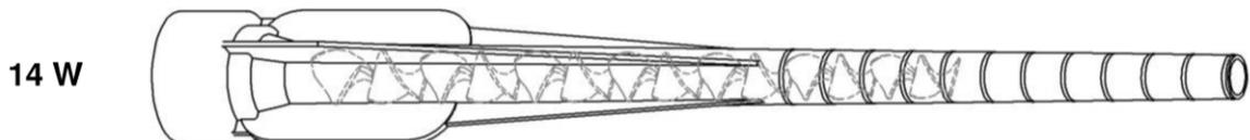
**Chemofast Injektionssystem STVK+ oder STVK+ Nordic für Beton**
