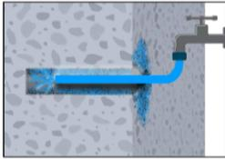
2a. Mit Wasser ausspülen, bis klares Wasser aus dem Bohrloch austritt.
