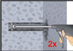
2d. Das Bohrloch vom Bohrlochgrund her 2x vollständig mit Druckluft (min. 6 bar) und geeigneter Ausblasdüse gem. Tabelle B5 ausblasen. Bei tiefen Bohrlöchern sind geeignete Verlängerungen zu verwenden.
