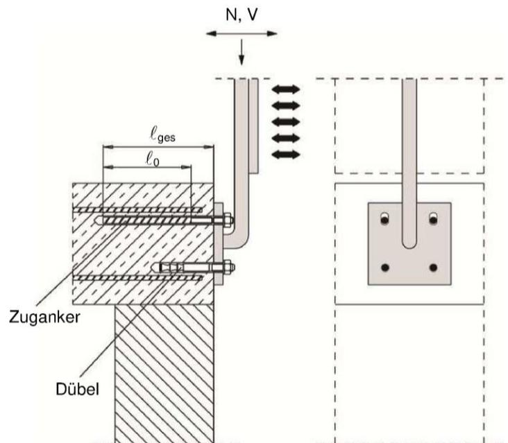
**Bild A8:** Übergreifungsstoß für die Verankerung von auskragenden Bauteilen
