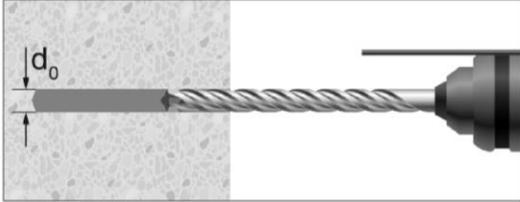
Erstellung des Bohrloches mit der Bohrlochtiefe  $h_1$ .
