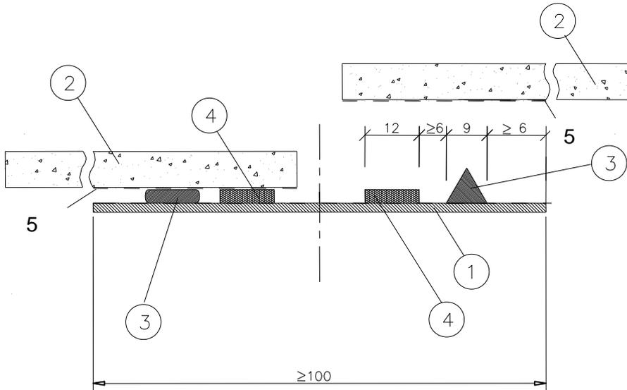
2. Klebeverbindung im Plattenmittelfeld und auf Endprofilen
