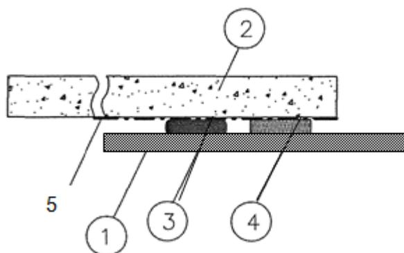
Fassadensystem unter Verwendung des Klebesystems "Innotec Project System" zur Befestigung von hinterlüfteten Fassadenplatten auf einer Aluminium-Unterkonstruktion
