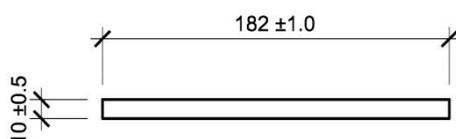
Material: Hochdruck-Schichtpressstoffplatte (HPL) entsprechend Abschnitt 2.1.1
