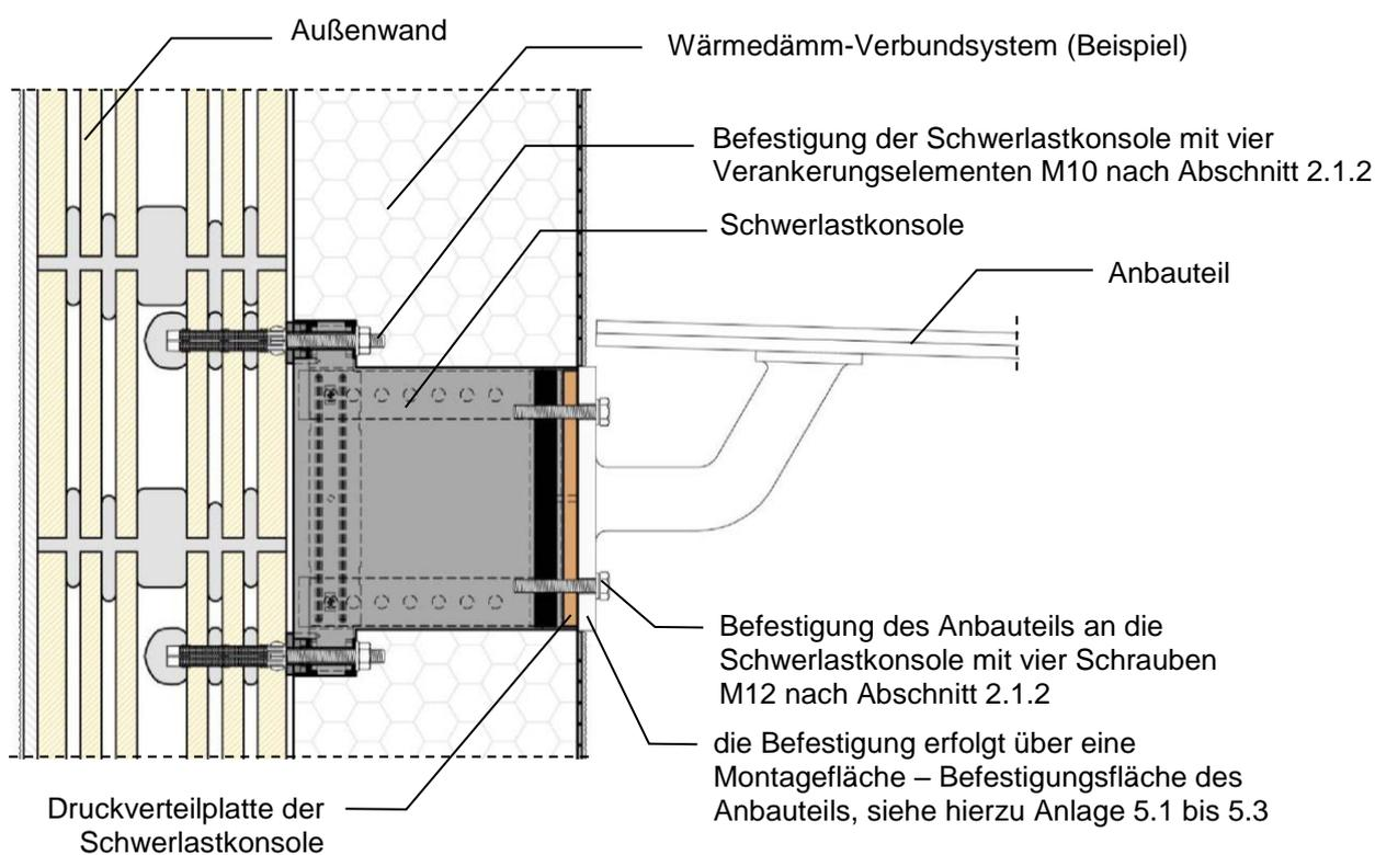
Die Befestigung der Schwerlastkonsole an der Außenwand muss zur Einhaltung der Durchknöpfftragfähigkeit über 4 Verbindungselemente M10 mit Scheibe nach Abschnitt 2.1.2 erfolgen.
