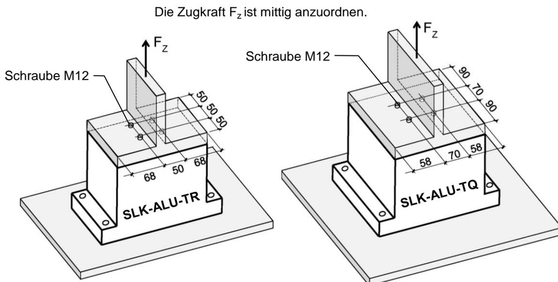
Befestigung zum Untergrund: Vier Verbindungselemente M10 entsprechend Abschnitt 2.1.2.
