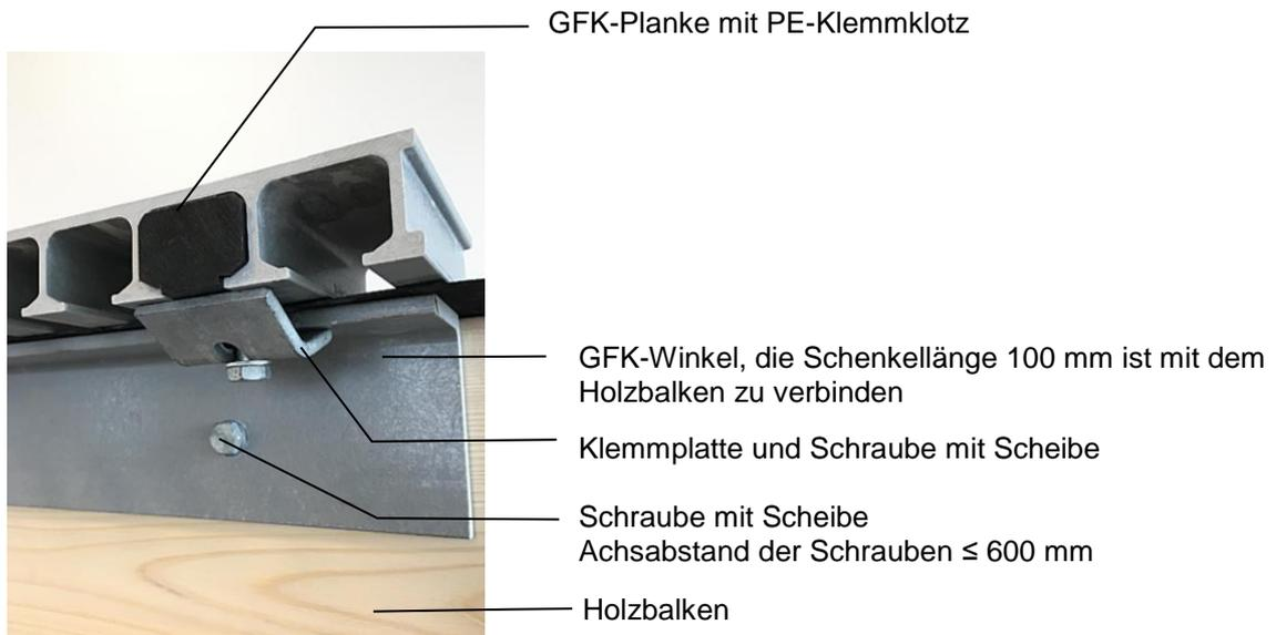
Befestigung mittels PE-Klemmklotz (s. Anlage 2.4), GFK-Winkel (s. Anlage 2.7) und Sechskant-Holzschraube M10 mit Stahlscheibe
