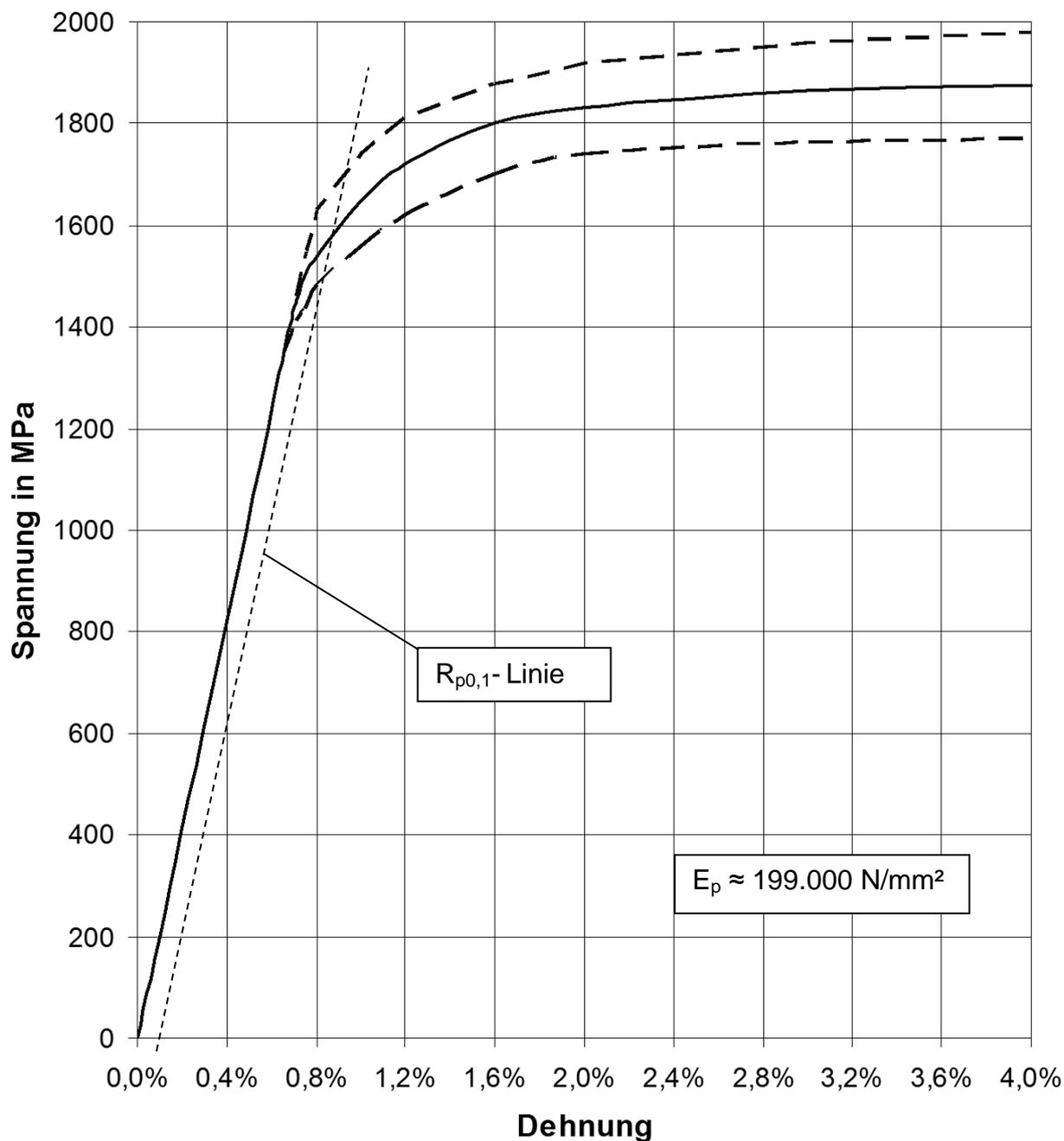
Die gestrichelten Linien markieren den Bereich, innerhalb dessen die tatsächliche Spannungs-Dehnungslinie auftreten kann.
