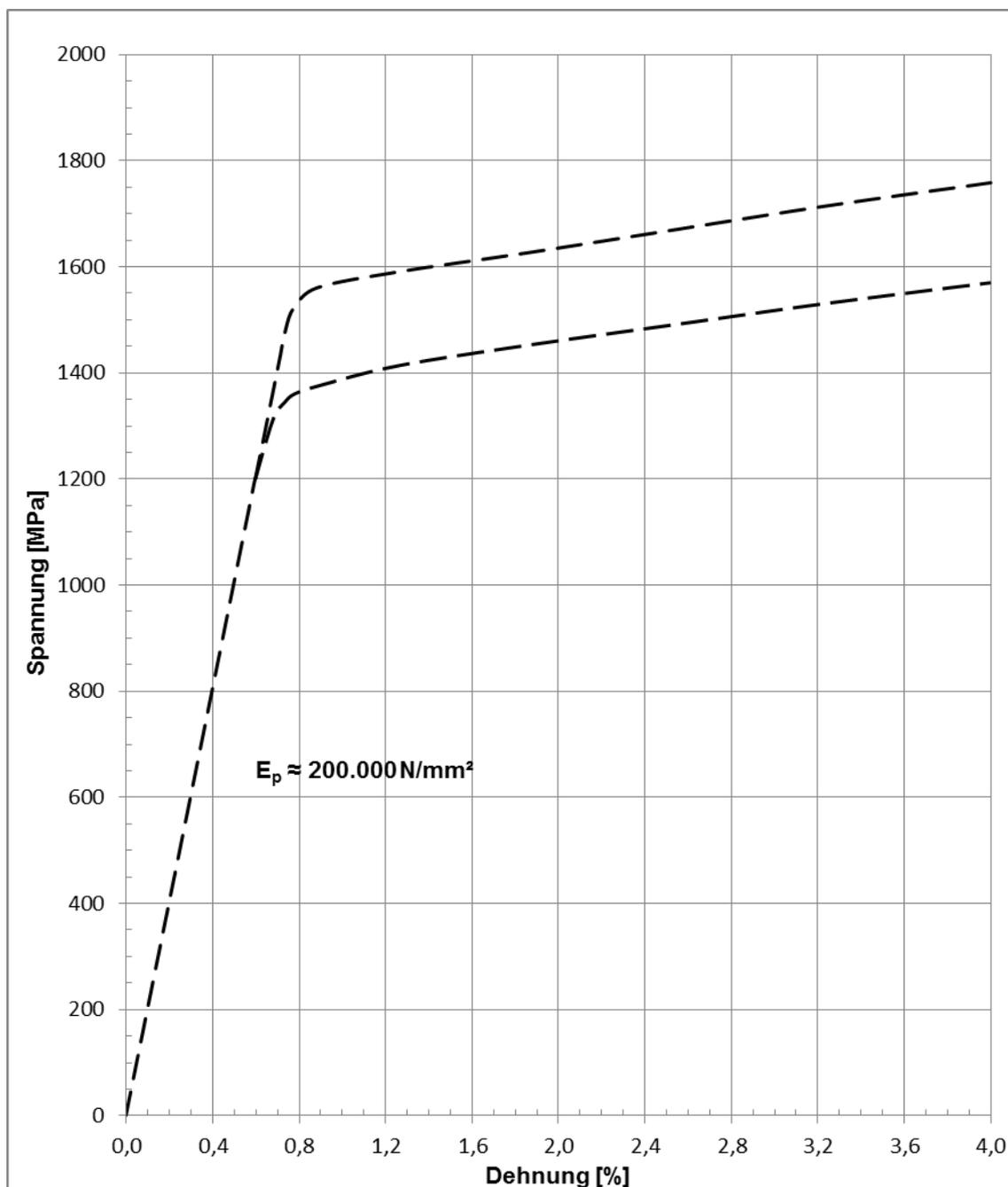
Die Linien geben eine Orientierung für den prinzipiellen Spannungs-Dehnungs-Verlauf bei Annahme des Rechenwerts des E-Moduls ( $E_p$ ) von 200.000 N/mm<sup>2</sup>.
