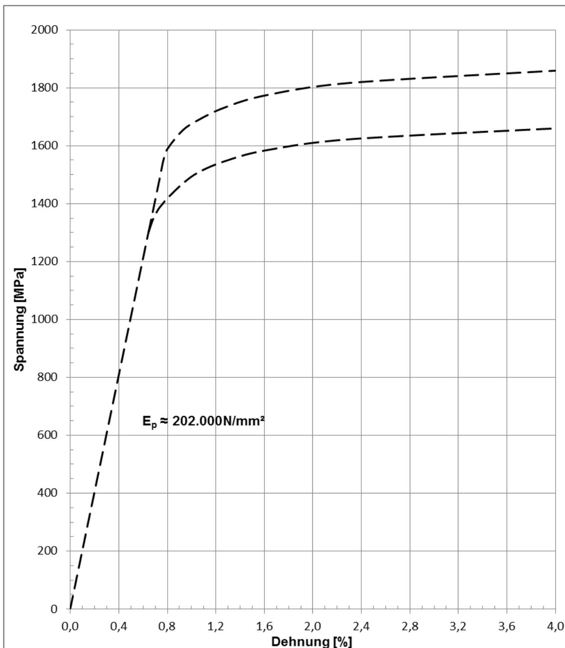
Die Linien geben eine Orientierung für den prinzipiellen Spannungs-Dehnungs-Verlauf bei Annahme des Rechenwerts des E-Moduls ( $E_p$ ) von 202.000 N/mm<sup>2</sup>.
